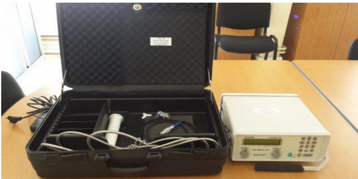
Figure (IV-49) : Débitmètre à ultrasons
