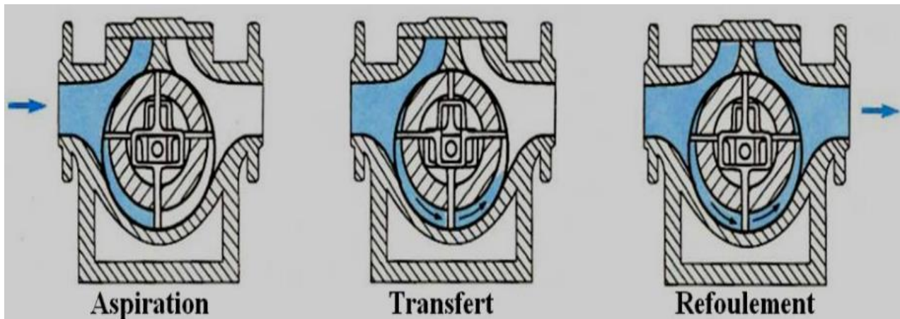
Figure (I.8) : Pompes à palettes guidées. [4]
