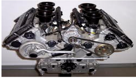
Figure. I.4. Moteur classique à combustion Interne V6 d'automobile [4].
