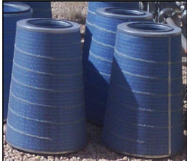
Figure I.17. Les filtres d'aspiration [17].
