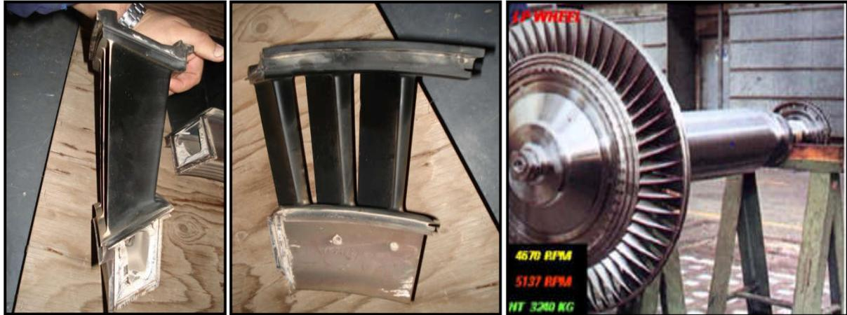
**Figure I.31.** Aube 2<sup>ème</sup> roue et Segment de la directrice. **Figure I.32.** Roue de turbine BP.
