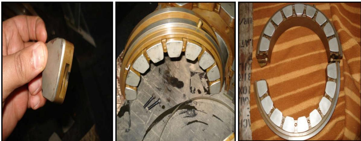
**Figure I.34.** Palier de Butée [17].
