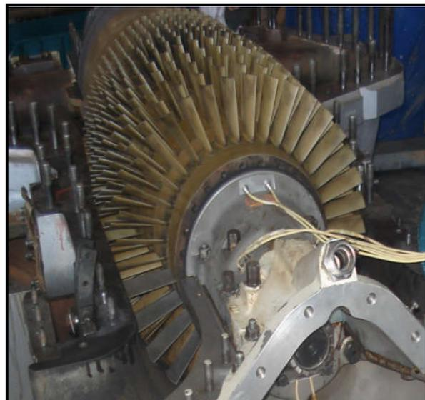
Figure I.18. Section compresseur [17].
