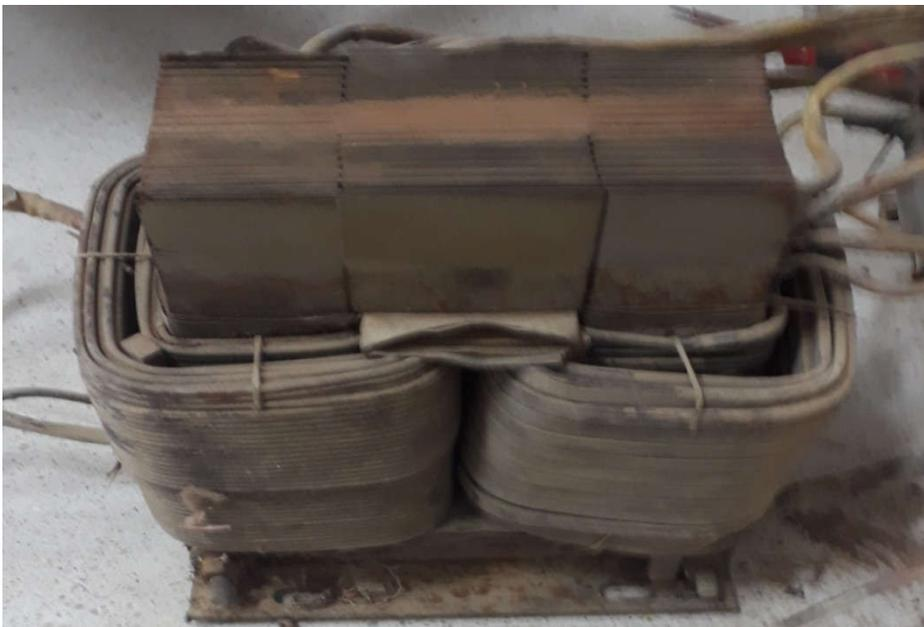
Figure III.1. transformateur d'un poste à souder endommagé
