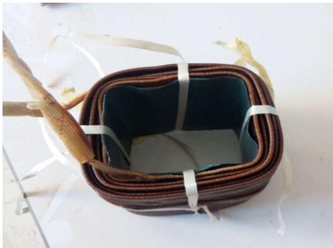
Figure III.4 le bobinage secondaire
