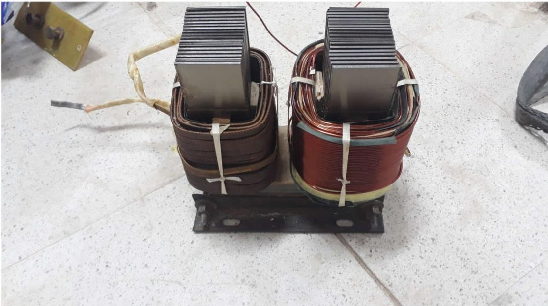
Figure.III.10. Bobinage primaire secondaire et place dans le circuit magnétique.
