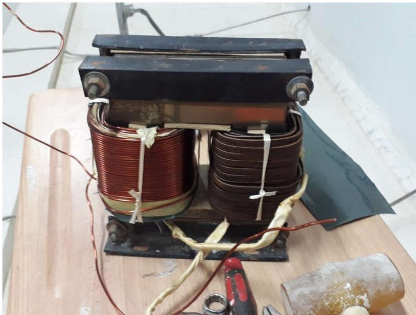
Figure.III.12. Serrage des tôles
