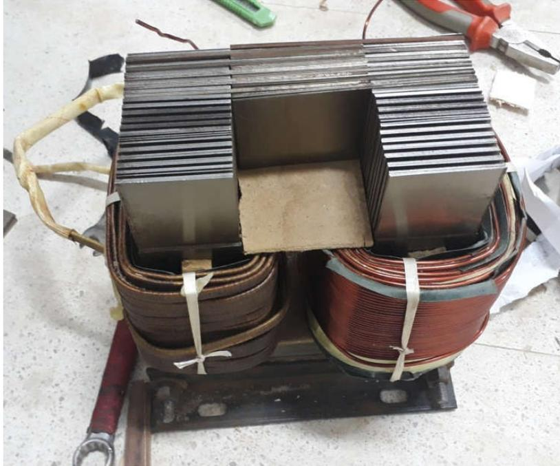
Figure.III.11. Remontage des tôles.
