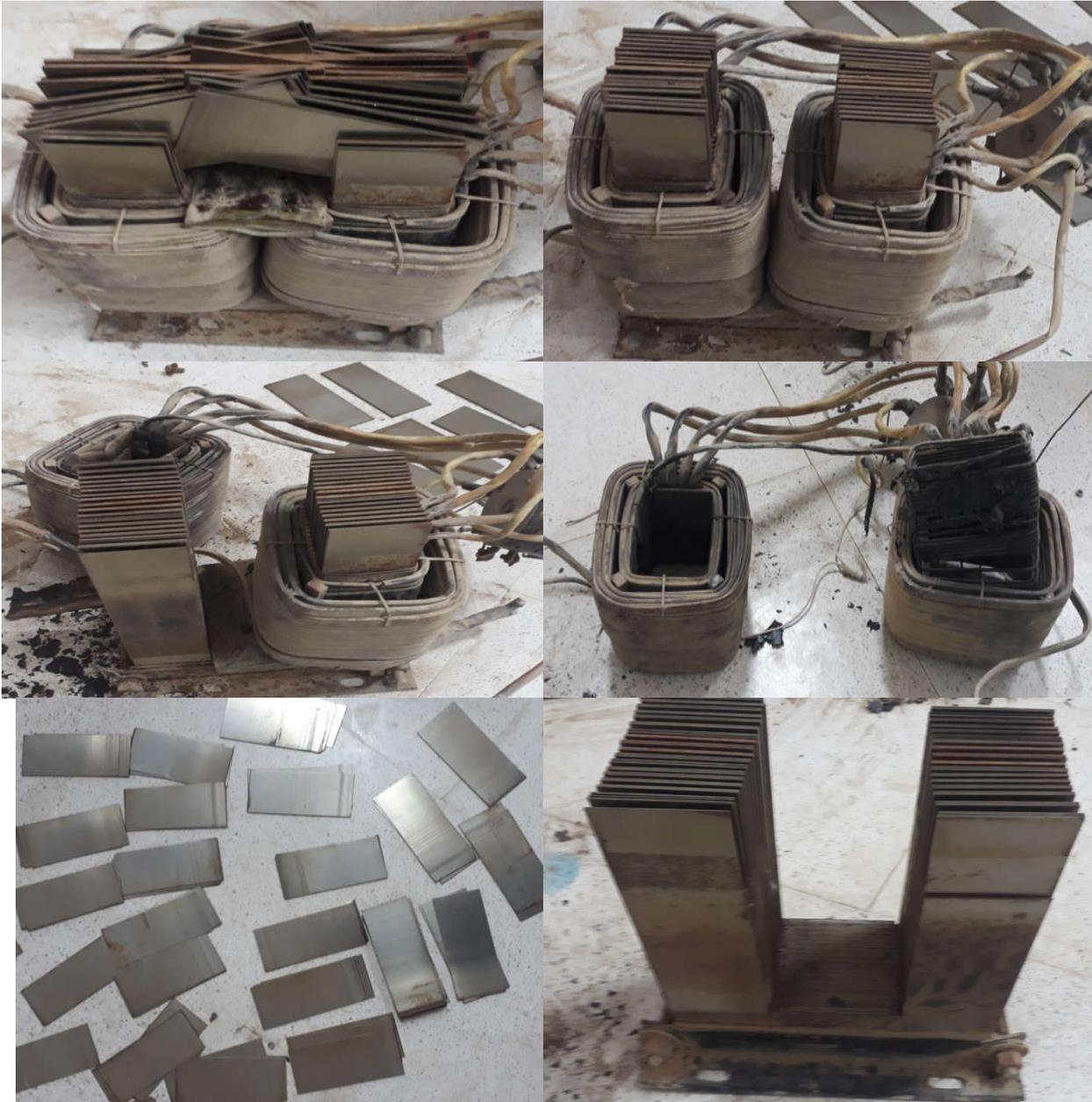
Figure III.2.démontage et nettoyage de notre transformateur
