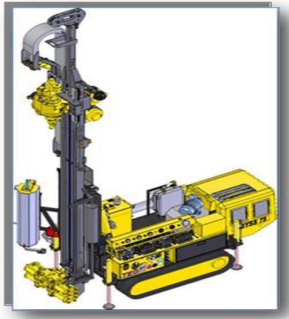
Figure.VI.1. Machine de forage géotechnique.
