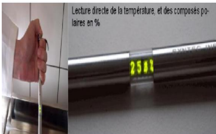
figure II.4 : Cet instrument permet de déterminer le taux des composés polaires issus de la dégradation des huiles de friture provoquée par la chaleur [7].
