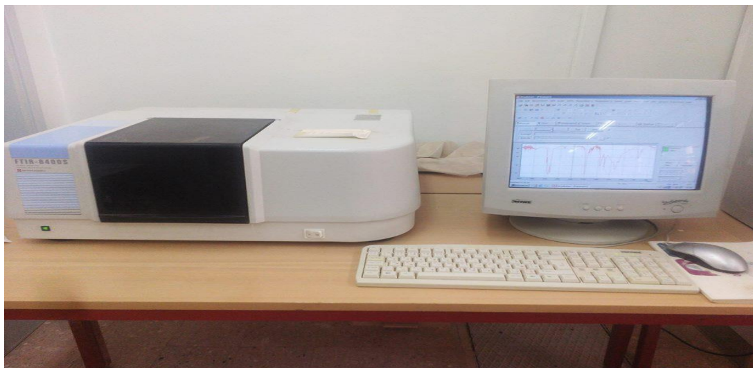
Figure .III.2: Spectromètre Infrarouge à transformée de Fourier utilisé.
