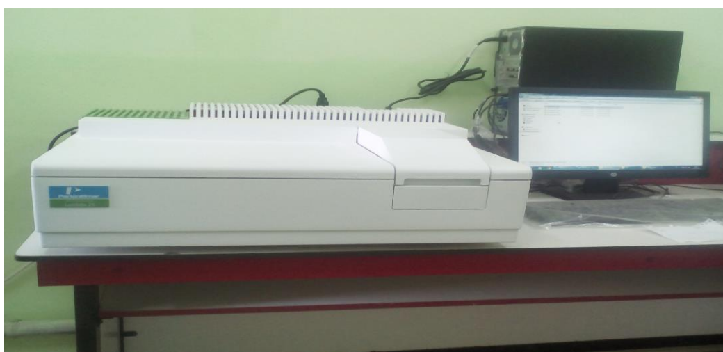
Figure .III.2: spectrophotomètre UV-visible utilisé.
