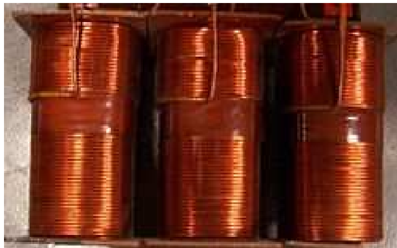
Figure II.7 : Photographie des enroulements d'un transformateur triphasé.
