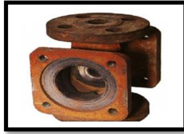
Figure 22 : Corrosion générale (rouille) d'une pièce en acier [34]
