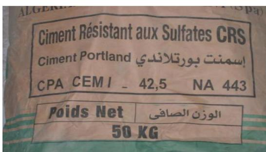
**Figure 6-A: ciment portland résistant aux sulfates (CPA CEM 42,5 CSR)**
