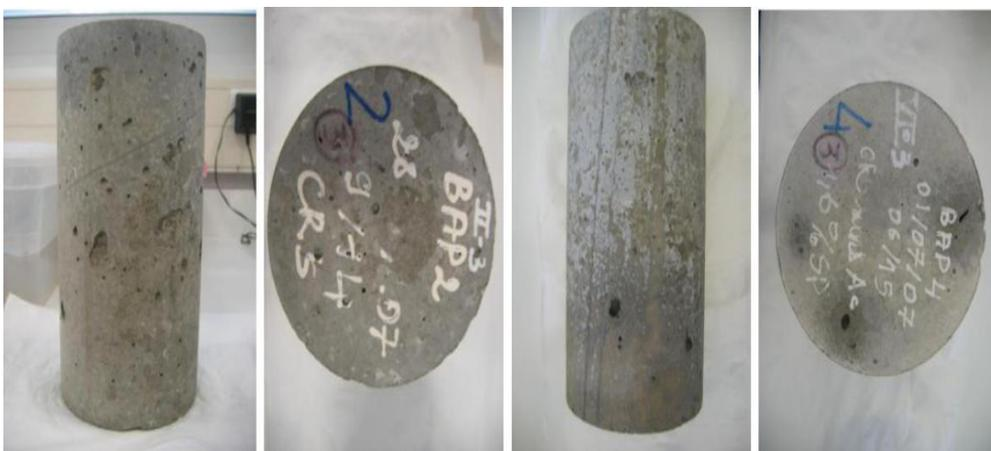
Figure 27-C : Etat intact des éprouvettes 11x22 cm en CEM I/59 et en CEM I/49 après 6 mois d'immersion complète
