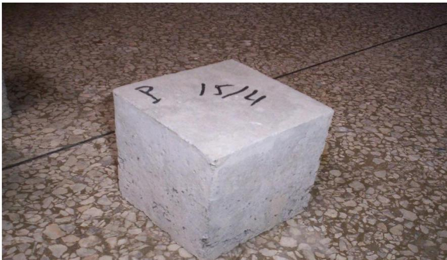
**Figure 29 :** Eprouvette cubique de  $10 \times 10 \times 10 \text{ cm}^3$
