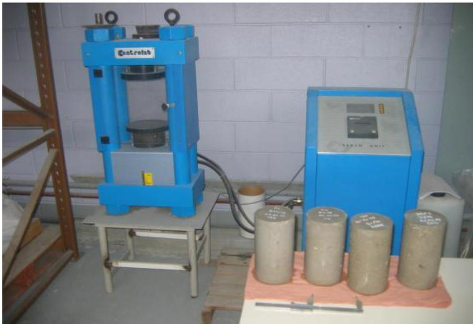
**Figure 23** : Presse des éprouvettes 11x22cm de l'Ecole Polytechnique d'Orléan
