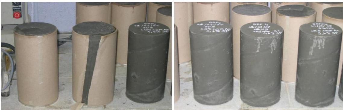
**Figure 24** : Confection des éprouvettes cylindriques en béton autoplaçant
