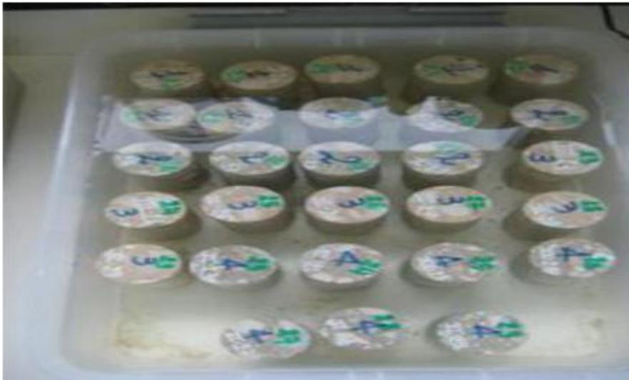
**Figure 25** : Immersion des échantillons de l'eau dosée à 5 % de  $\text{Na}_2\text{SO}_4 \cdot 10\text{H}_2\text{O}$
