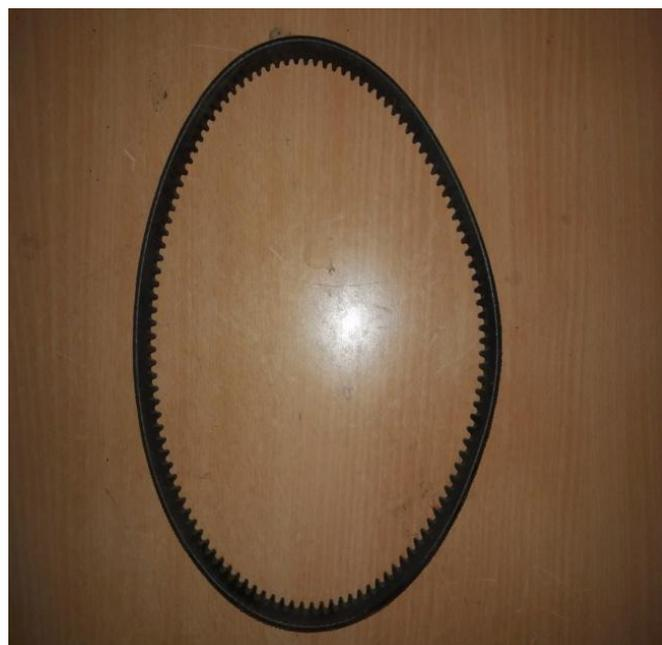
Figure IV-17 : Croie dentée d'alternateur.
