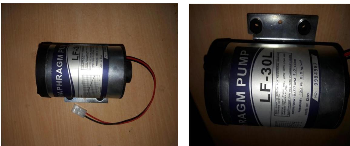
Figure IV-14 : Génératrice MCC d'une pompe DIAPHRAGM PUMP LF-30L
