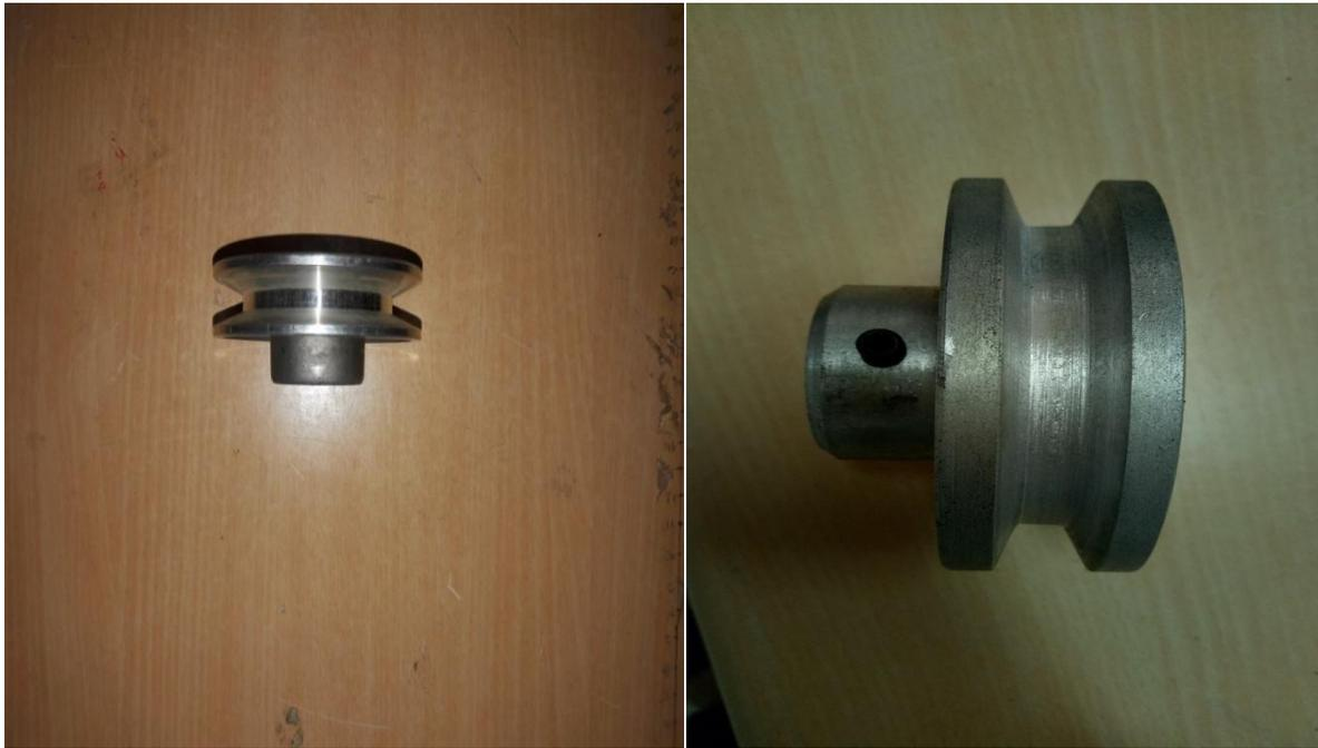
Figure IV-18 : Poulie à gauche est fixée sur l'arbre et la poulie à droite est fixé à la génératrice.
