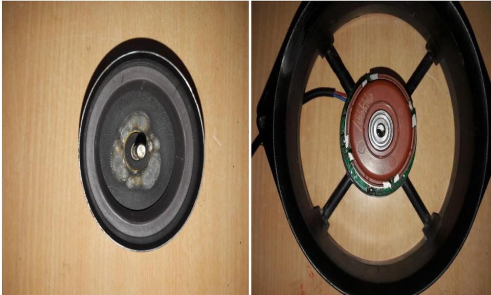
Figure IV-13 : Génératrice MSAP d'un ventilateur
