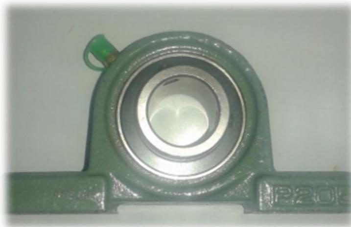
Figure IV-4 : le roulement de l'arbre.
