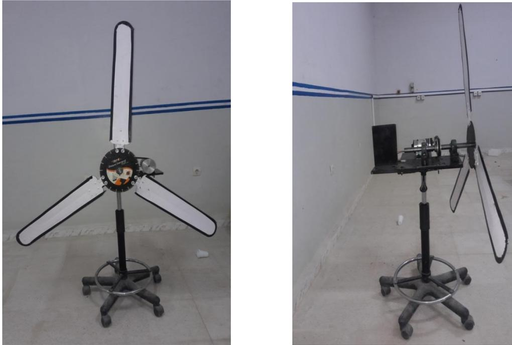
Figure IV-20 : L'ensemble : génératrice, croie, poulies arbre, disque et pales sont assemblés pour donner l'éolienne.
