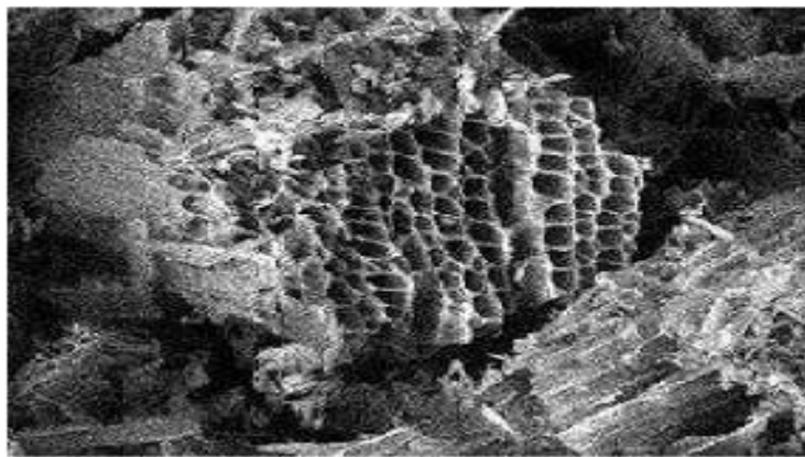
Figure II.2 : Structure du charbon actif vu sous un microscope électronique.
