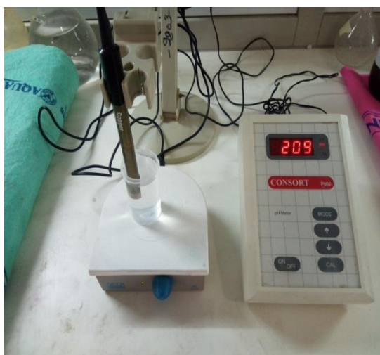
Figure 7 : Dosage du cuivre par colorimétrie, électrode combinée spécifique (CONSORT, ISE 25B).
