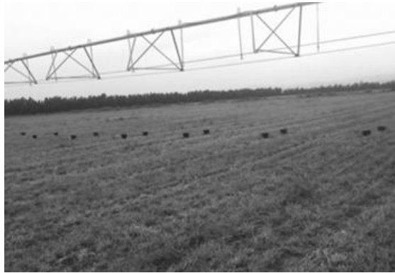
Figure 1: Disposition des récipients pour mesurer la pluviométrie et l'uniformité de la distribution des eaux d'irrigation pour la rampe pivotante.
