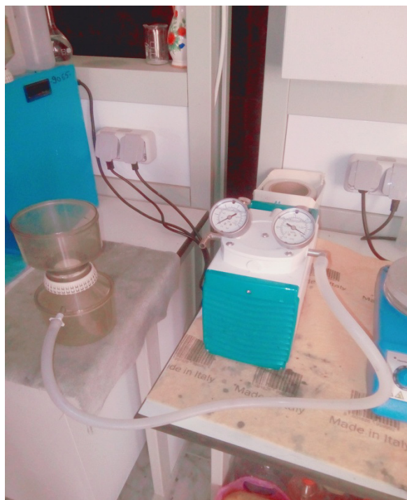
Figure 6.3 : Pompe sous vide
