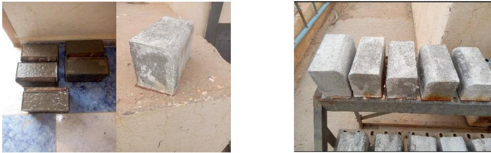
Figure (III.12) Blocs fusibles à arête amont arrondie après fabrication
