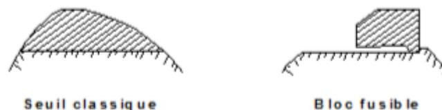
Figure (I.40) Bloc fusible placé sur un seuil après un araselement.
