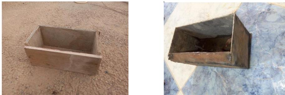
**Figure (III.10)** Moules en bois et métallique
