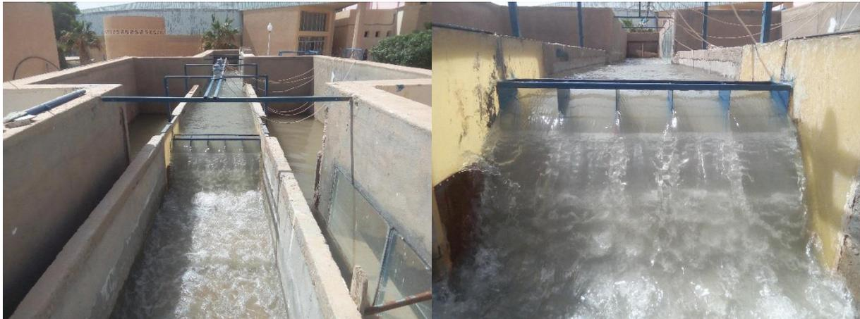
**Figure (III.17)** Essai de calcul du coefficient de débit
