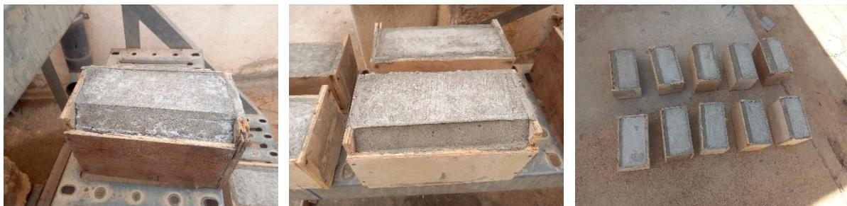
**Figure (III.11)** Blocs fusibles à arête amont chanfreinée après fabrication
