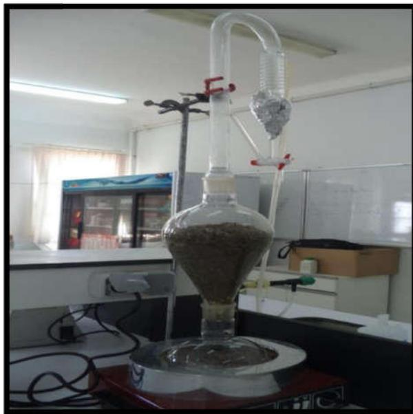
**Figure 4.** Montage de la distillation par entrainement à la vapeur d'eau (Type Clevenger).
