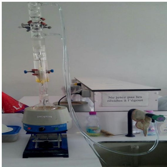
Figure 3. Montage d'extraction par l'appareil de Soxhlet
