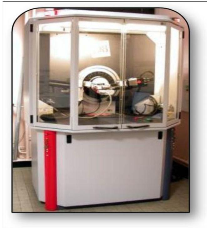
**Figure II.8:** Photographie du diffractomètre de type (Bruker D8 Advance).
