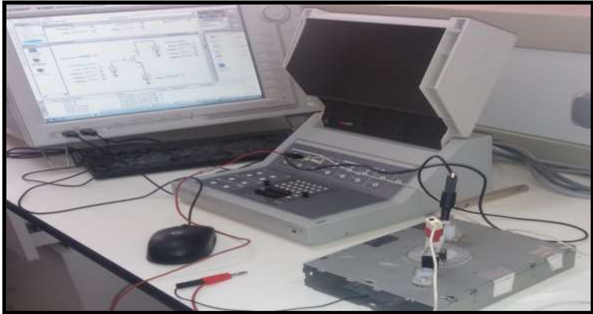
Figure III.1 : L'appareil de l'analyseur à semi-conducteur KEYSIGHT B1500A montrant
