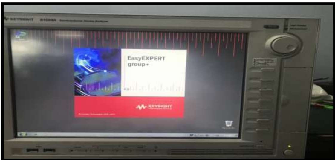
Figure II .1: Représentation de l'appareil analyseur de dispositif à semi-conducteur KEYSIGHT B1500A.
