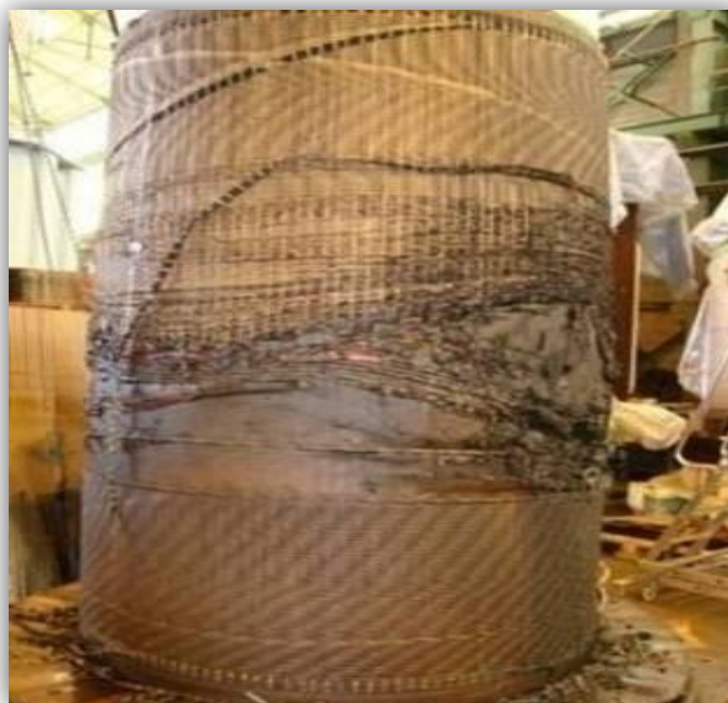
Fig. III.2. Amorçage franche entre spires [6]
