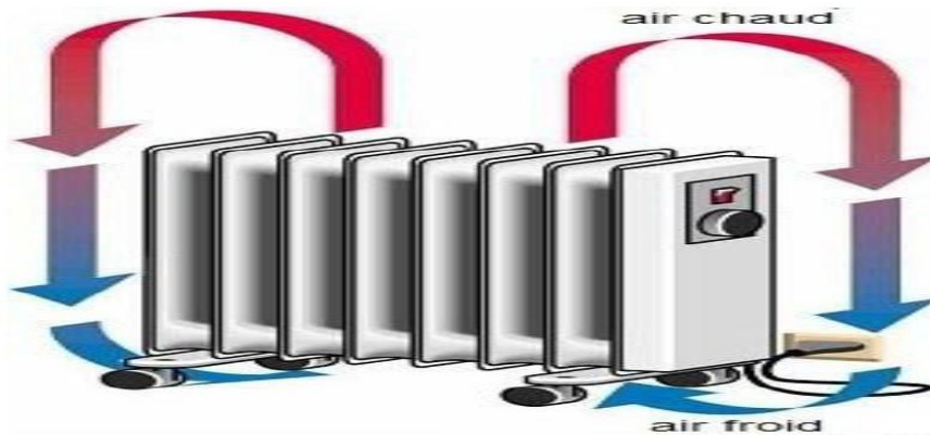
Figure I.6: Transfert de chaleur par convection d'un convecteur électrique [1].
