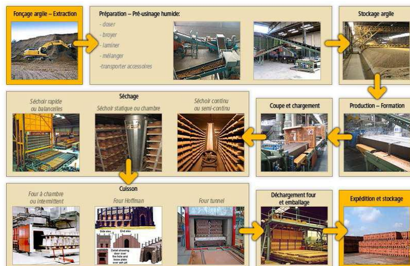
Figure I.1 les différentes étapes de fabrication de brique.
