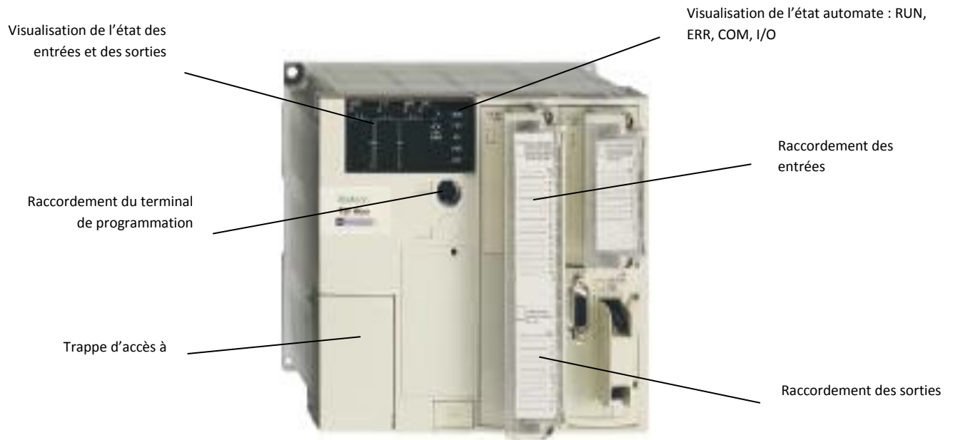
Figure 3.2 Structure générale d'un automate programmable TSX Micro.
