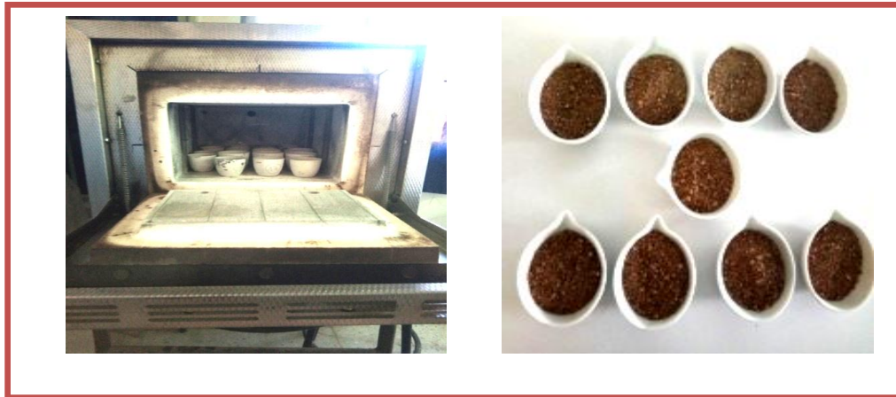
Figure III. 01: Séchage des noyaux d'abricots ( t = 2\text{heurs} ; T= 200^{\circ}\text{C} )
