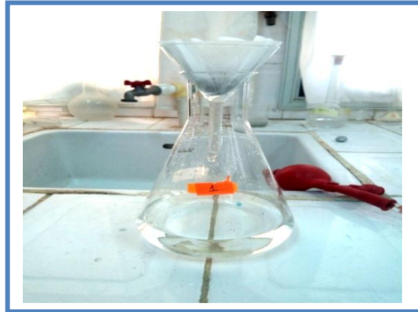
Figure III. 06 : étape de lavage de charbon actif par acide chlorhydrique HCl (0.1N)
