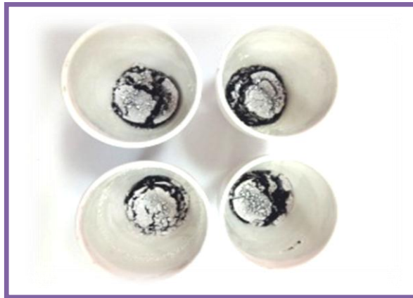
Figure III. 05 : le charbon actif après la carbonisation à ( t = 4h , T = 600^{\circ}C )
