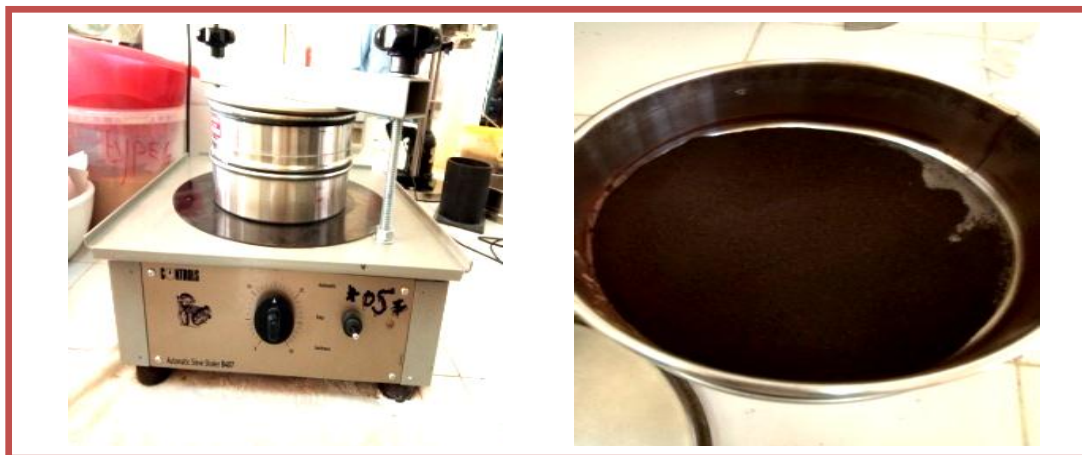
Figure III. 03 : tamisages des noyaux d'abricots ( d < 0.01 \text{ nm} )
