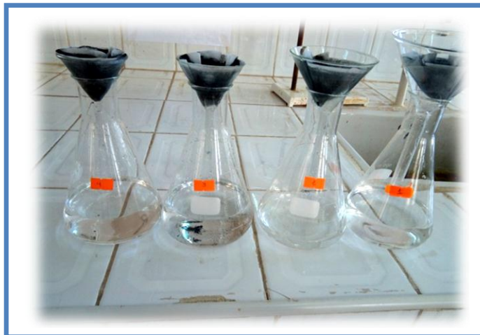
Figure IV. 09 : étape de filtration de charbon actif (noyaux d'abricots)
