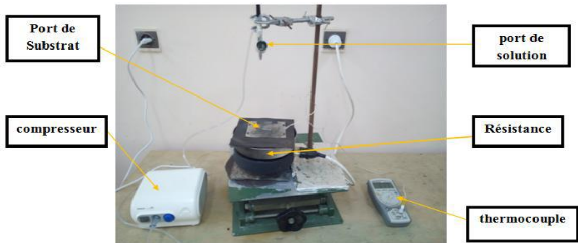
Figure III. 1: montage expérimental du système de spray pneumatique.
