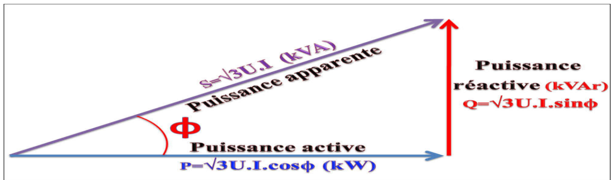
Figure 3.13 : Composition vectorielle des puissances actif, réactif et apparent
