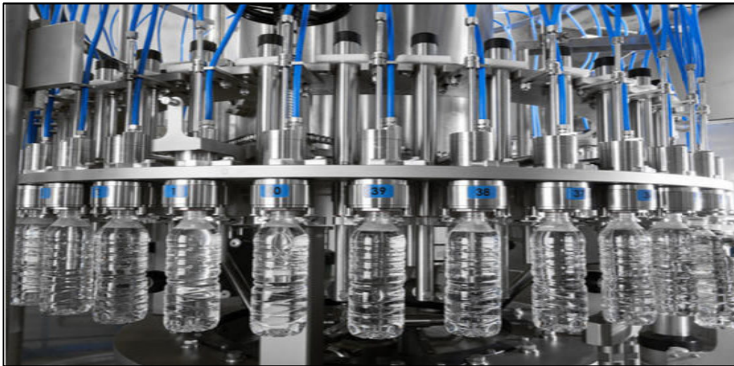
FigI.12 : Remplisseuse de bouteilles.
