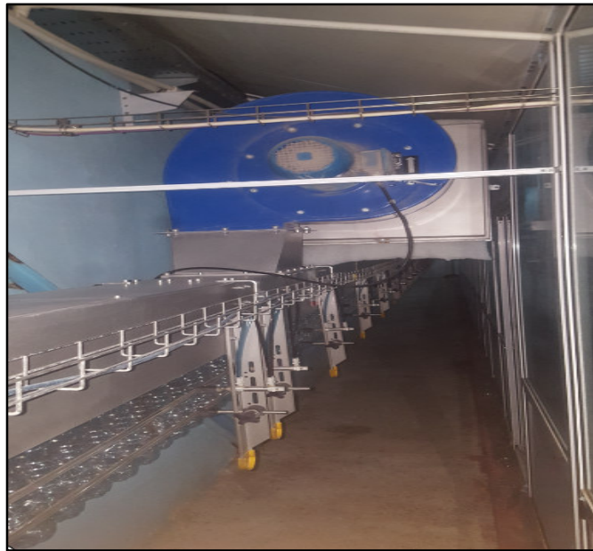
FigI.10 : Convoyeur aérien de bouteilles.
