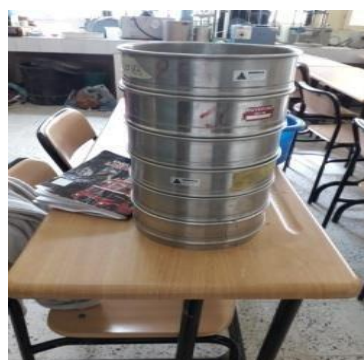
Figure 2.1. : Série des tamis utilisé pendant les essais granulométriques (source internet)
