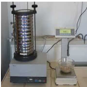
Figure 2.1. : Série des tamis utilisé pendant les essais granulométriques (source internet)
