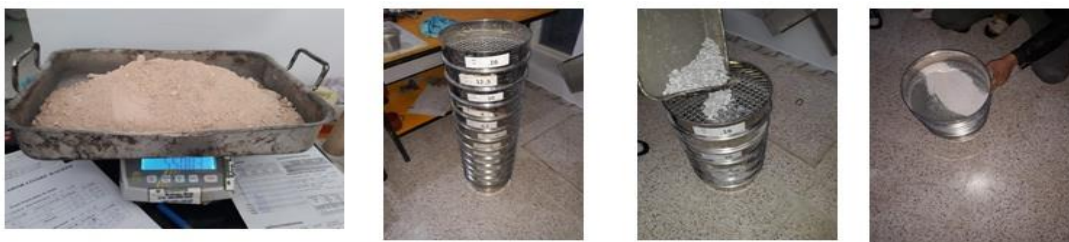
Figure 28: les phases de l'essai analyse granulométrique
