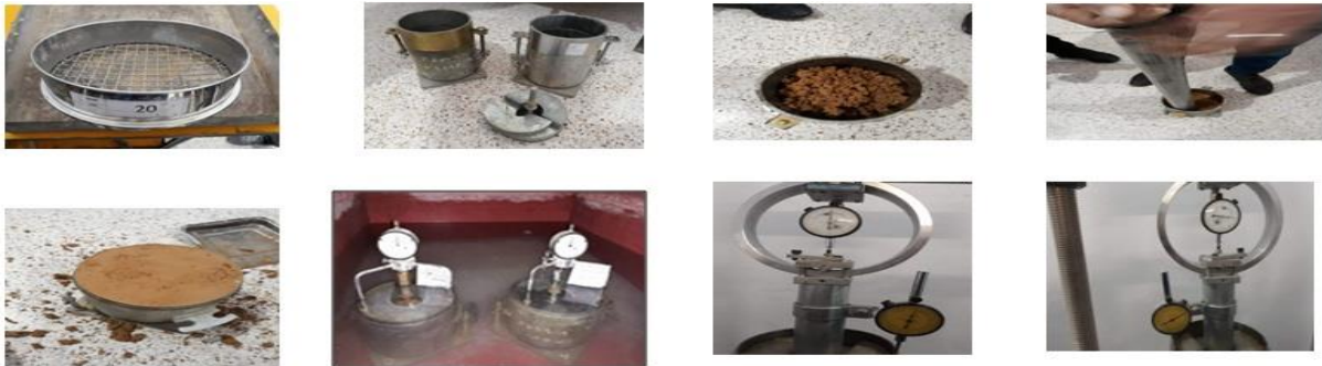
Figure 31 : les phases de l'essai CBR en laboratoire :
