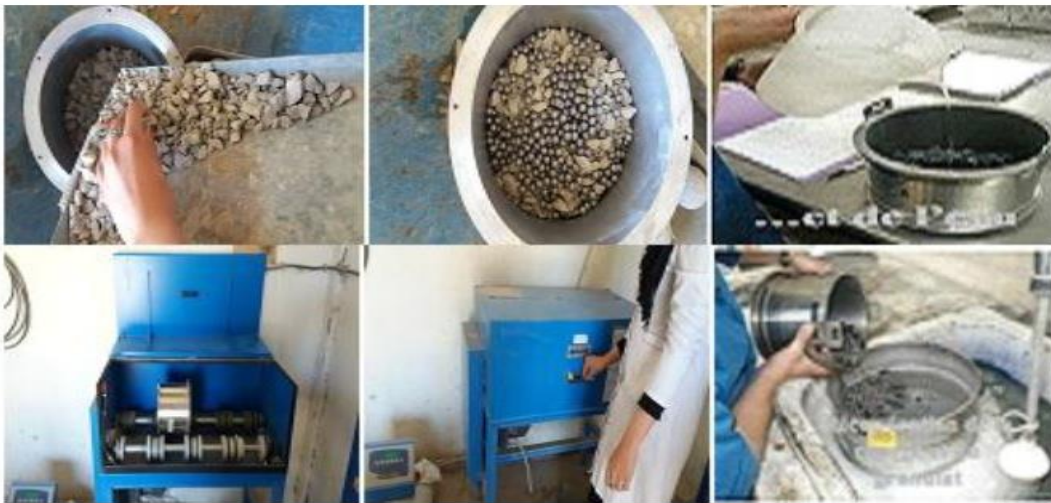
Figure 33: les phases de l'essai MICRO-DEVAL
