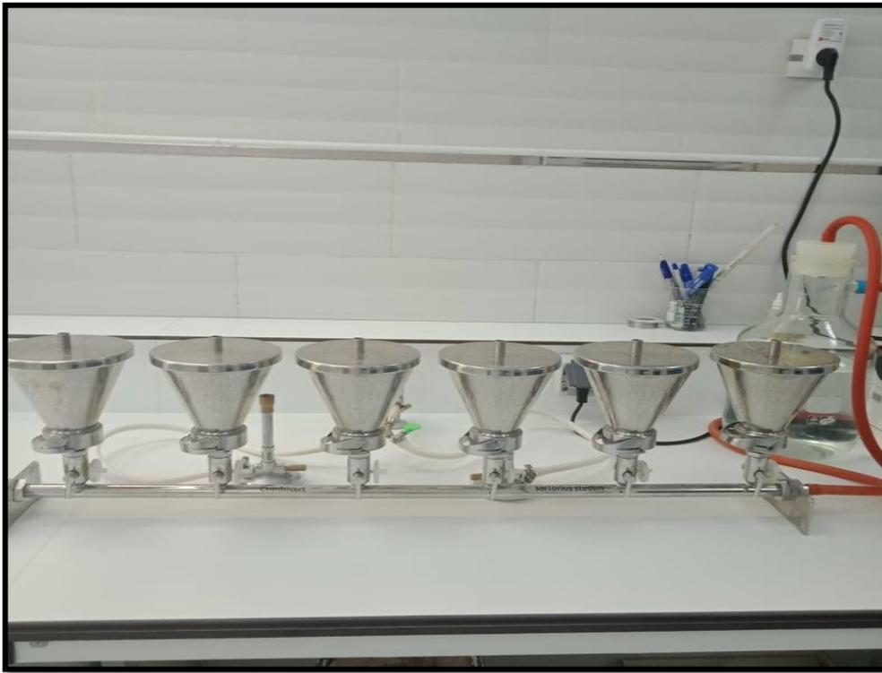
**Figure 4 .** Technique de filtration sur membrane.
