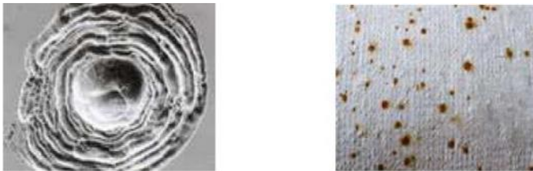
Figure I. 4: corrosion par piqûres
