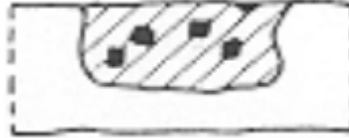
Figure. I. 8 : Corrosion et dissolution sélective
