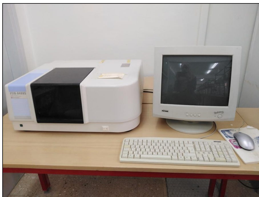
Figure II.23 : Schéma de principe du spectrophotomètre FTIR et Spectromètre infrarouge FTIR utilisé.
