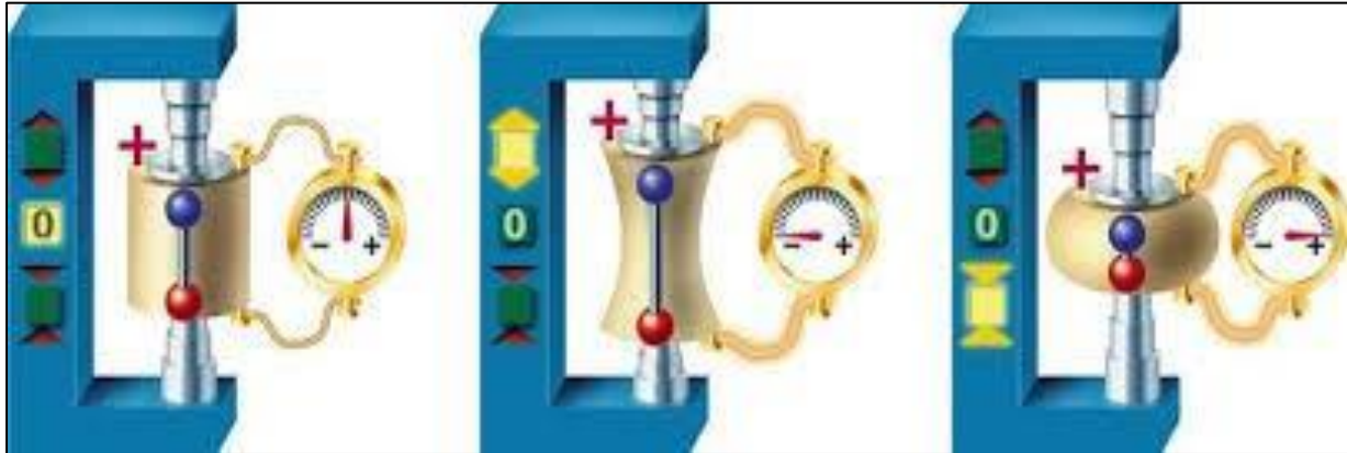
Figure I.5 : Effet piézoélectrique directe.
