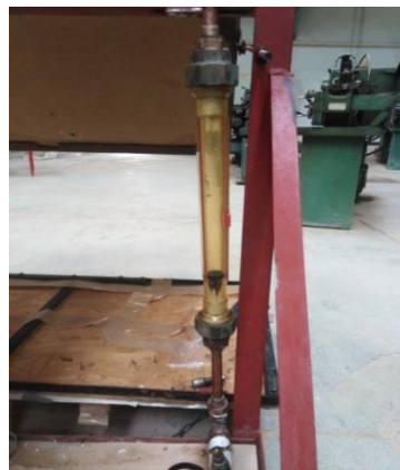
Figure III.13 : Débit mètre à flotteur gradué de 0 à 160 l/h.
