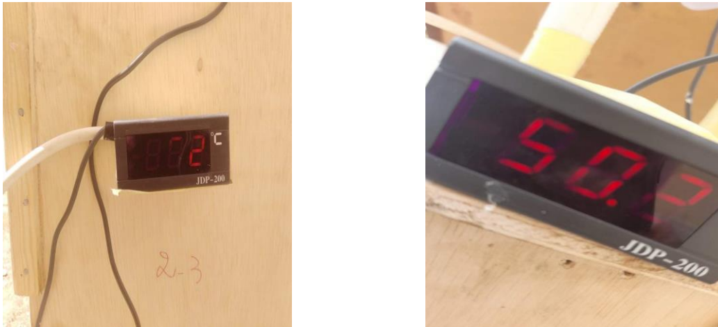
Figure III.14 : thermomètres digital JDP-200 avec écran afficheur.
