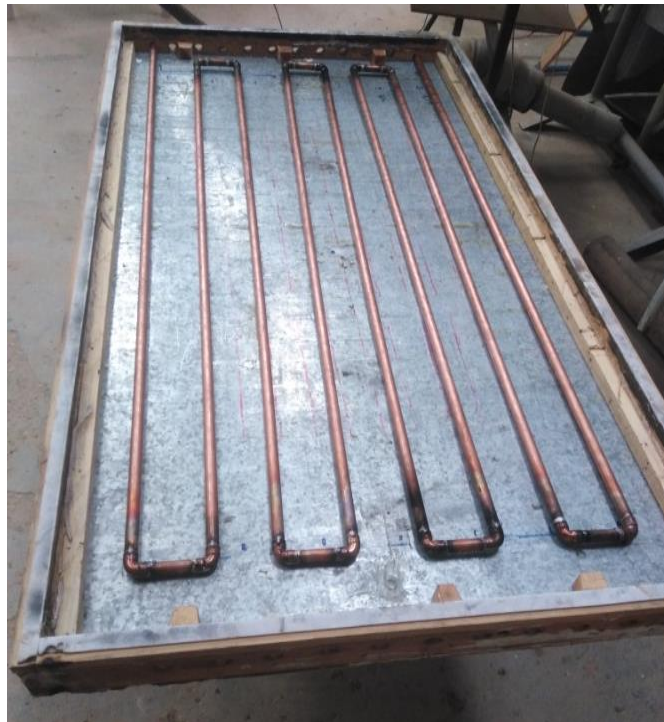
Figure III.2 : Absorbeur en tube de cuivre en forme de serpentин.
