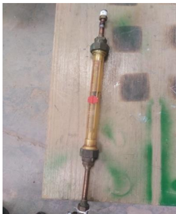
Figure III.13 : Débit mètre à flotteur gradué de 0 à 160 l/h.
