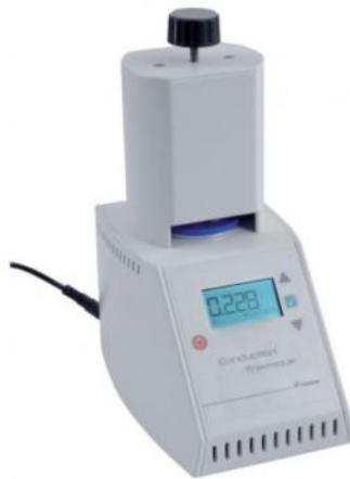
Figure I.3 : Appareil de mesure de la résistance thermique Réf. 08090.10
