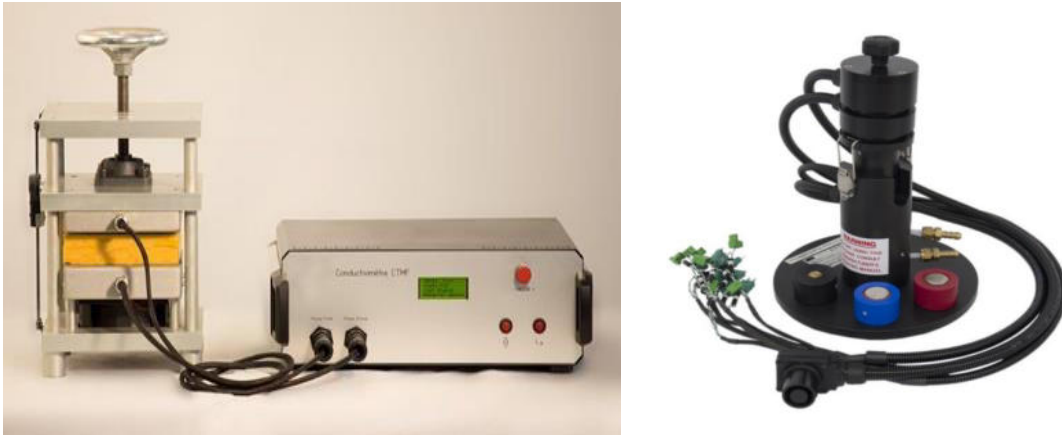
Figure I.4 : Conductivimètre par la Méthode des Fluxmètres
