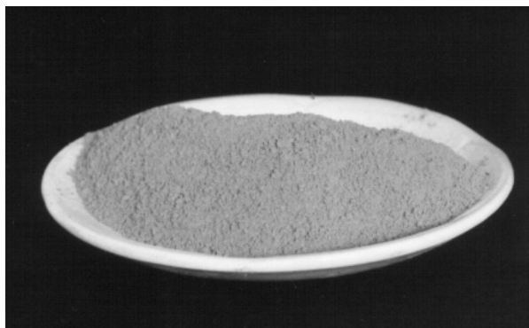
Photographie 1 : Vase de Beni Amrane, obtenue après cuisson et broyage
