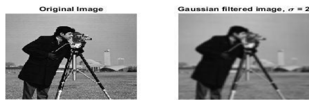
Figure 2. 13 : Comparaison entre : (à gauche) sans filtre Gaussien et (à droite) avec filtre Gaussien [42].
