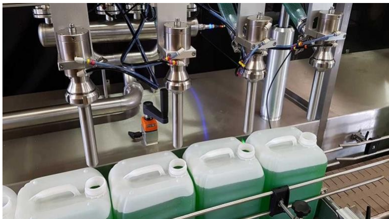
FIGURE I.5 – La ligne de remplissage des bidons
