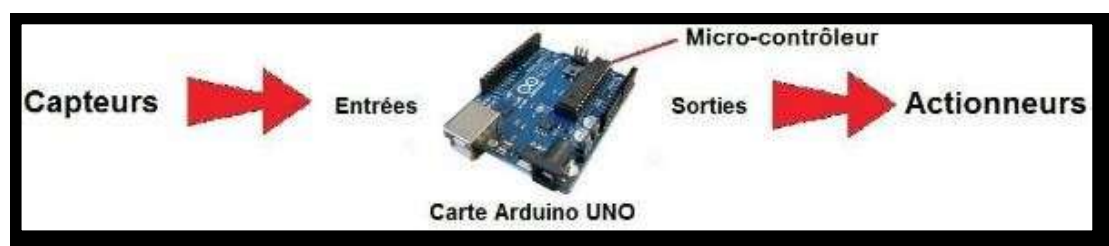
Figure (II.1): Présentation (capteurs + actionneurs) de la carte Arduino
