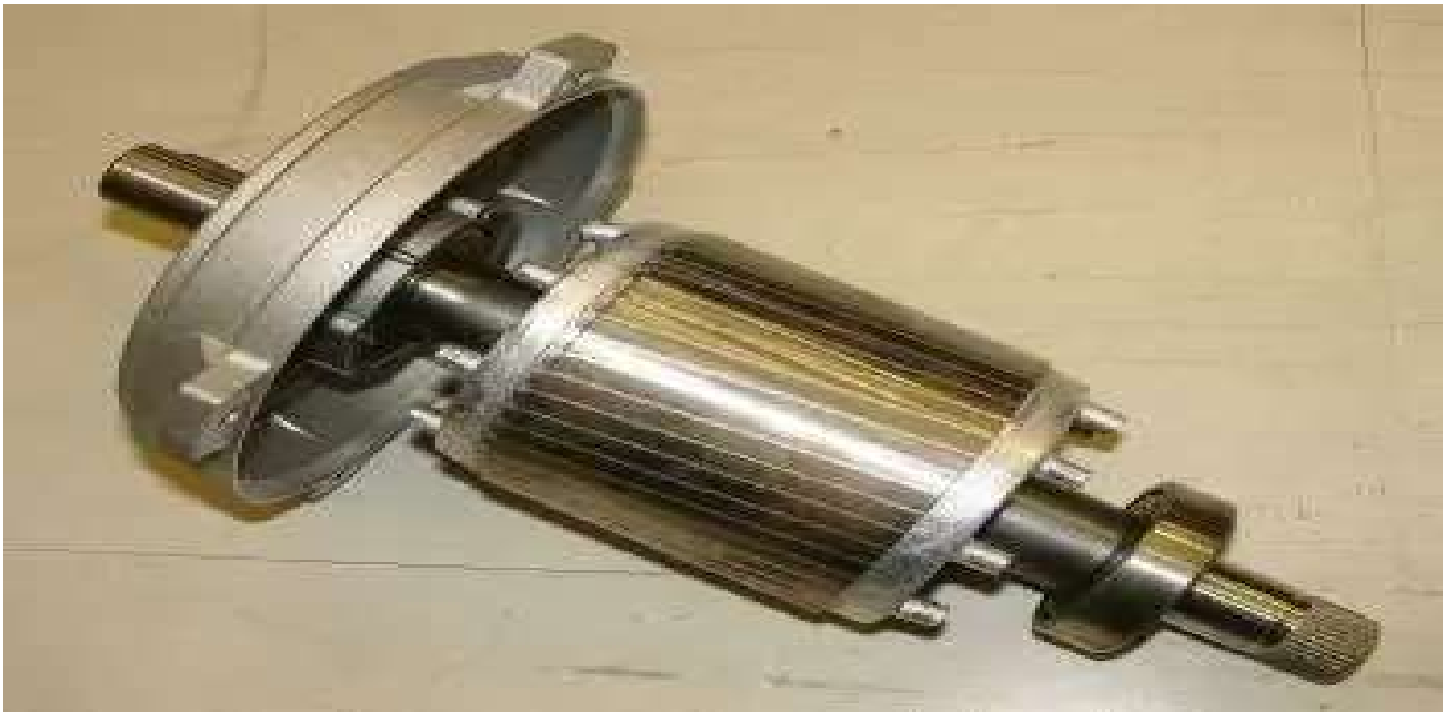
Figure ( I.15) : Rotor à cage [39]
