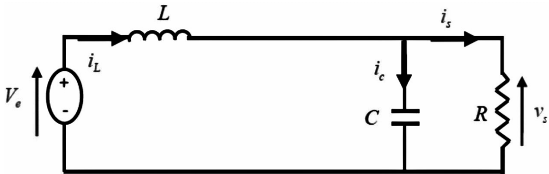
Figure I.5 : Circuit équivalent du Boost quand l'interrupteur est ouvert.
