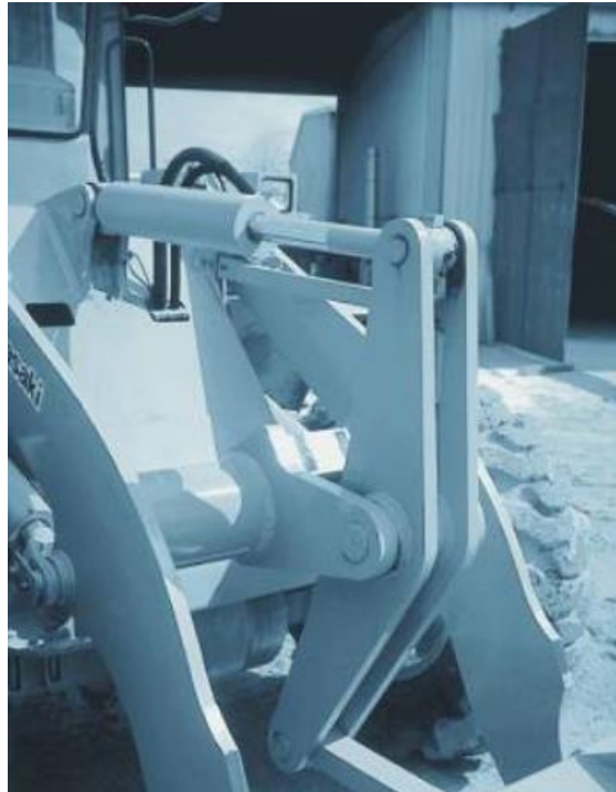
Figure II.13. De nombreux éléments de la machine sont à broches connecté afin de permettre une rotation libre à leurs connexions. Ces supports exercent une force sur un membre, mais pas de moment.
