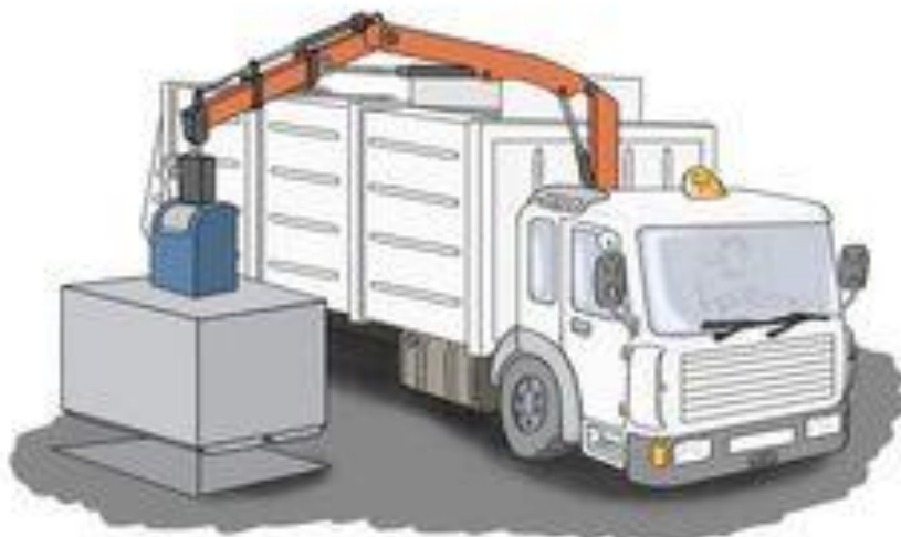
Figure II.2. Vidange du conteneur à déchets avec un camion-grue à crochet.
