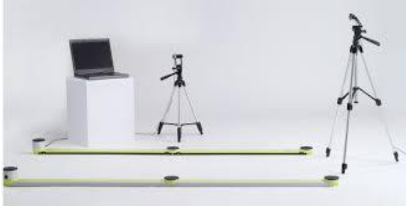
الصورة رقم 09 : تعبر عن الجهاز المستخدم في اختبارات سرعة رد الفعل (OPTOJUMP)
