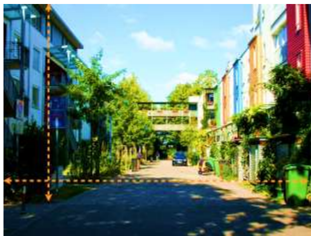
Figure II.2 : Relation confortable entre la largeur de la rue et la hauteur des bâtiments
