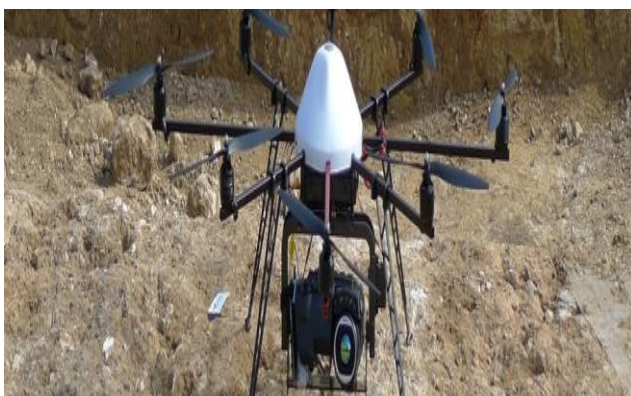
Figure I.11 : Camera infra rouge aéroporté par un drone. (Source : Beaufrère et al. 1999)
