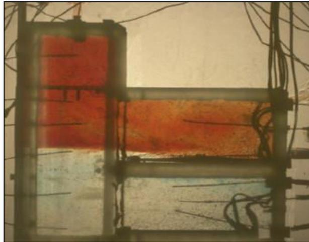
**Figure II-2** : Photo d'un modèle à petite échelle rempli avec de l'eau pour la visualisation d'écoulement d'un bâtiment de deux étages avec un atrium commun. **Source:** (S.R. Livermore, A.W. Woods, 2007) .
