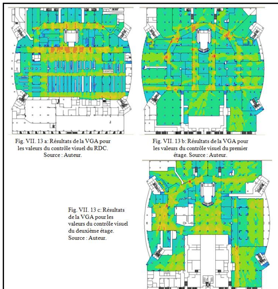
Fig. VII. 13: Résultats de la VGA pour les valeurs du contrôle visuel du centre commercial BAB EZZOUAR, cas : portes ouvertes. Source : Auteur.
