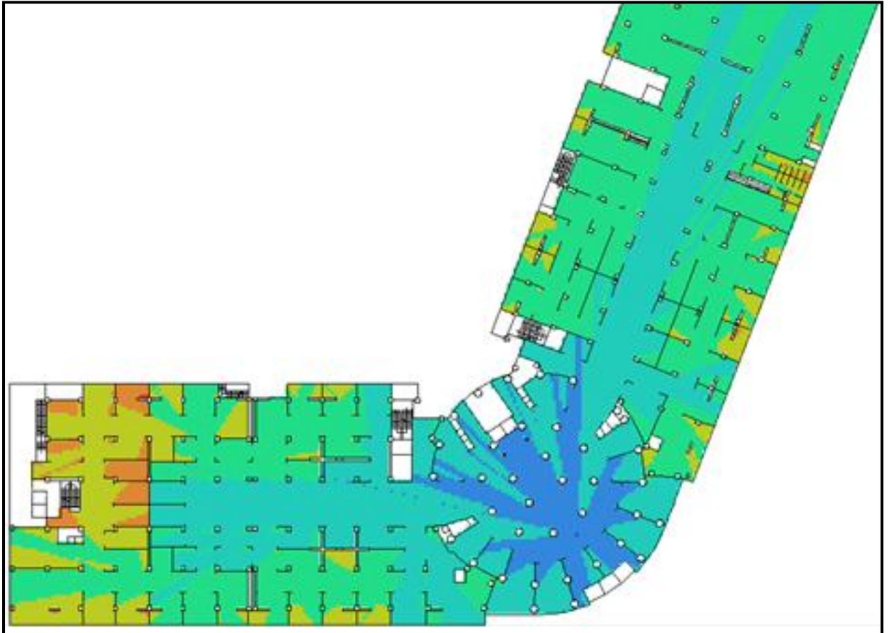
Fig. VII. 20 a: Résultats de la VGA pour les valeurs de la step depth du sous-sol.
