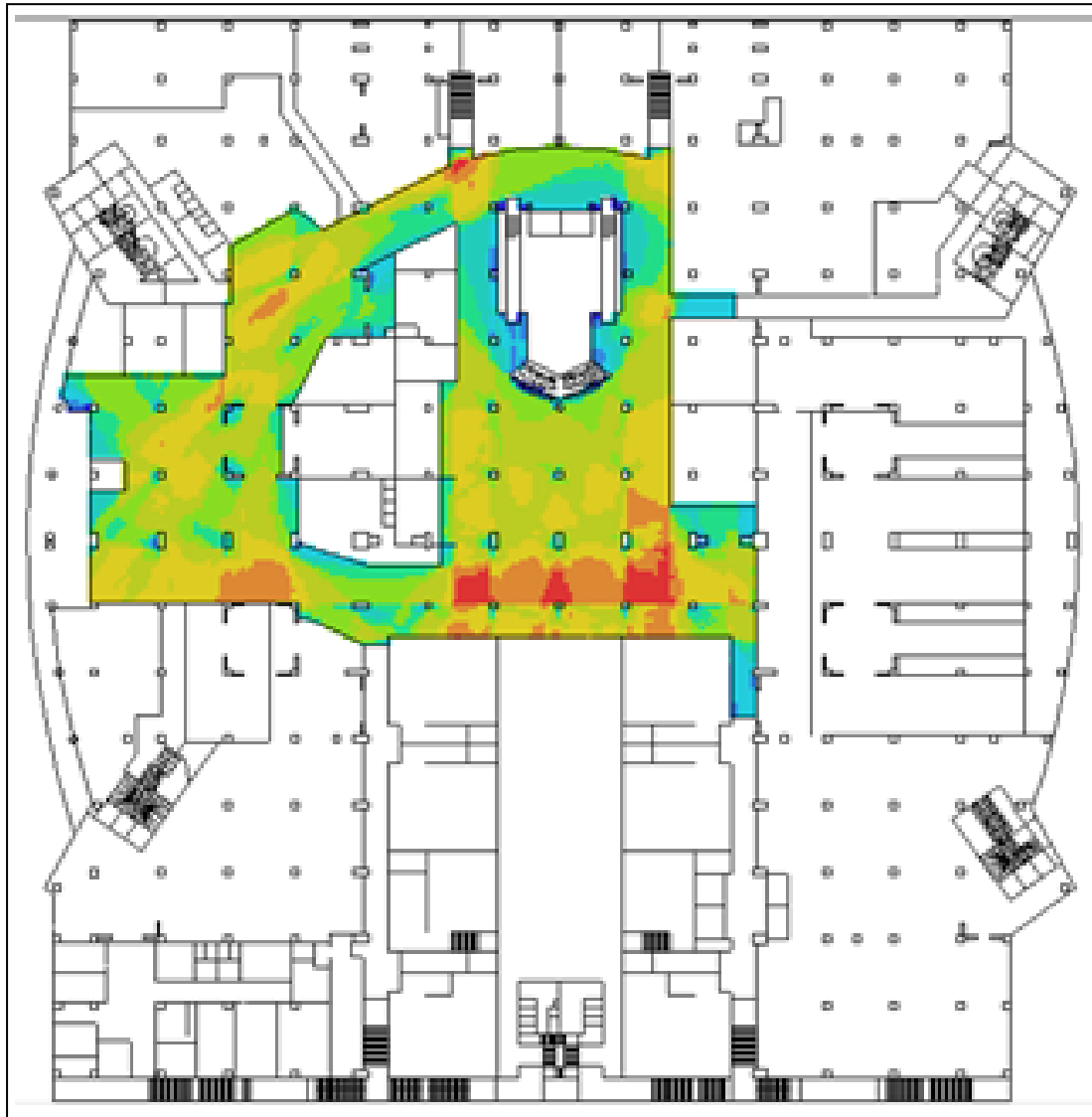
Fig. VII. 25 c: Résultats de la VGA pour les valeurs du contrôle visuel du deuxième étage. Source : Auteur.
