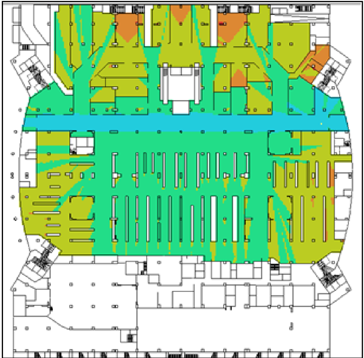
Fig. VII. 17 a: Résultats de la VGA pour les valeurs de la step depth du RDC.
