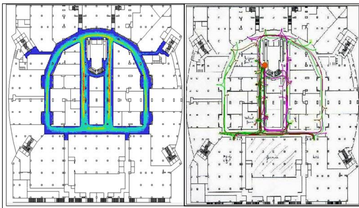
Fig. VIII.24. Confrontation du schéma de l'observation aux résultats de l'analyse multi-agents pour le premier étage. Source : Auteur
