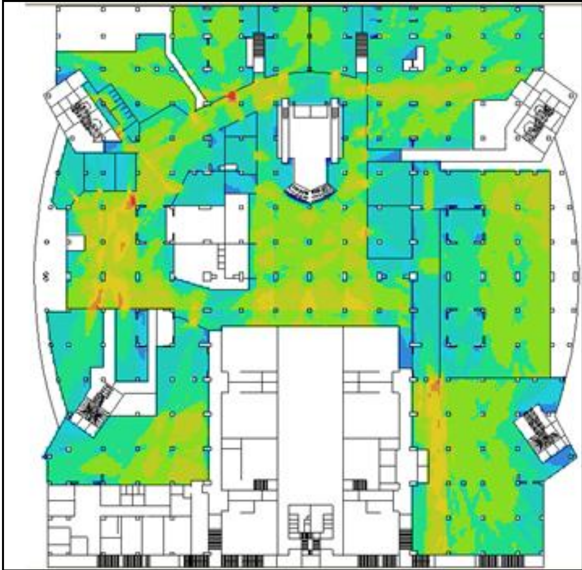
Fig. VII. 13 c: Résultats de la VGA pour les valeurs du contrôle visuel du deuxième étage. Source : Auteur.
