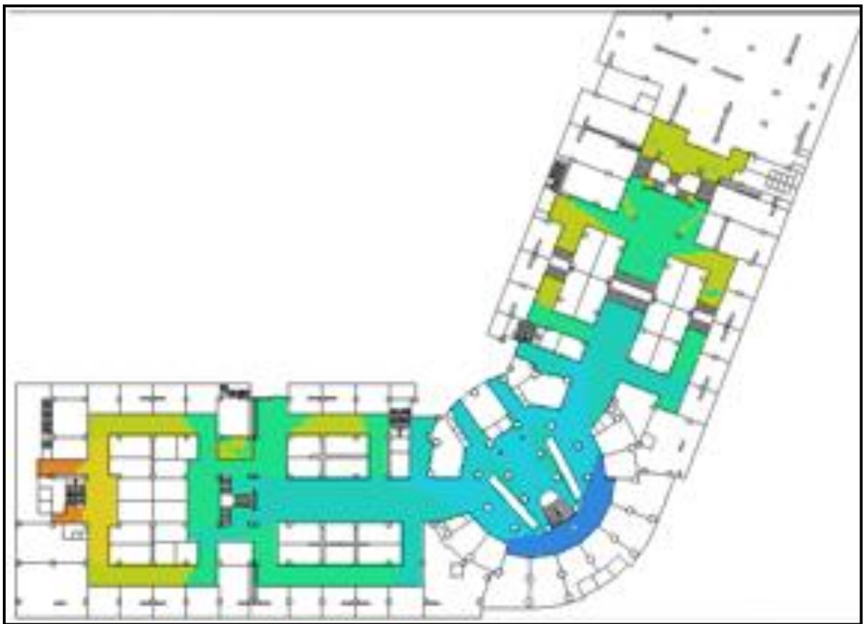
Fig. VII. 29 d: Résultats de la VBA pour les valeurs de la step depth du sous-sol.
