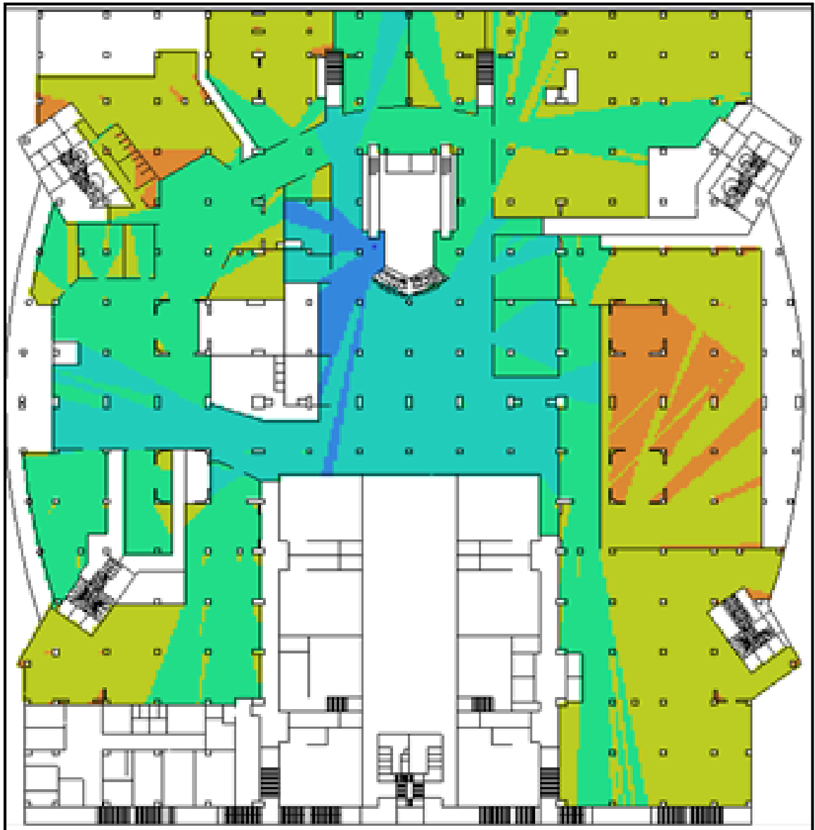
Fig. VII. 17 c: Résultats de la VGA pour les valeurs de la step depth du deuxième étage. Source : Auteur.
