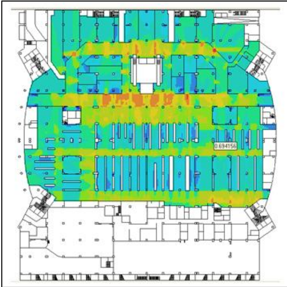
Fig. VII. 13 a: Résultats de la VGA pour les valeurs du contrôle visuel du RDC.
