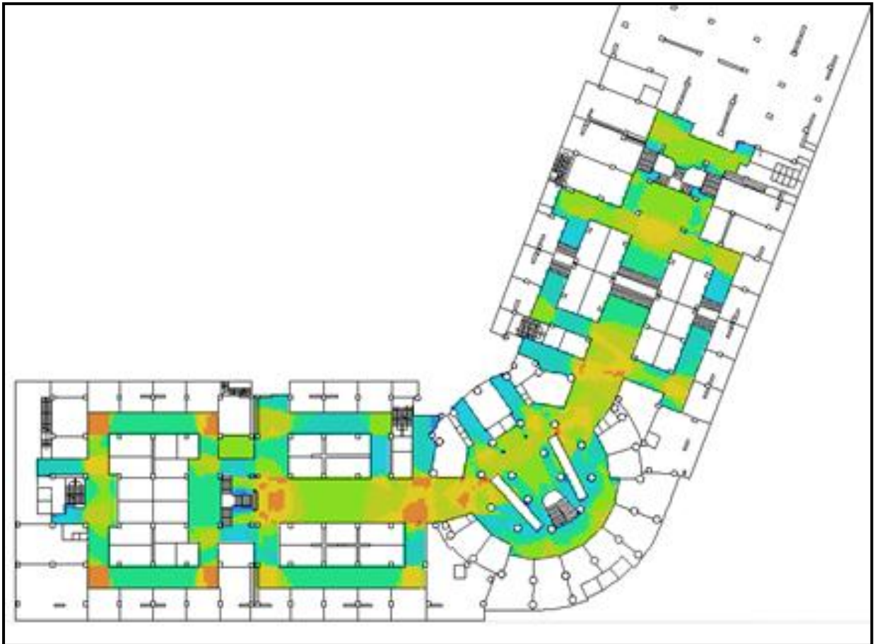
Fig. VII. 27 a: Résultats de la VGA pour les valeurs du contrôle visuel du sous-sol.
