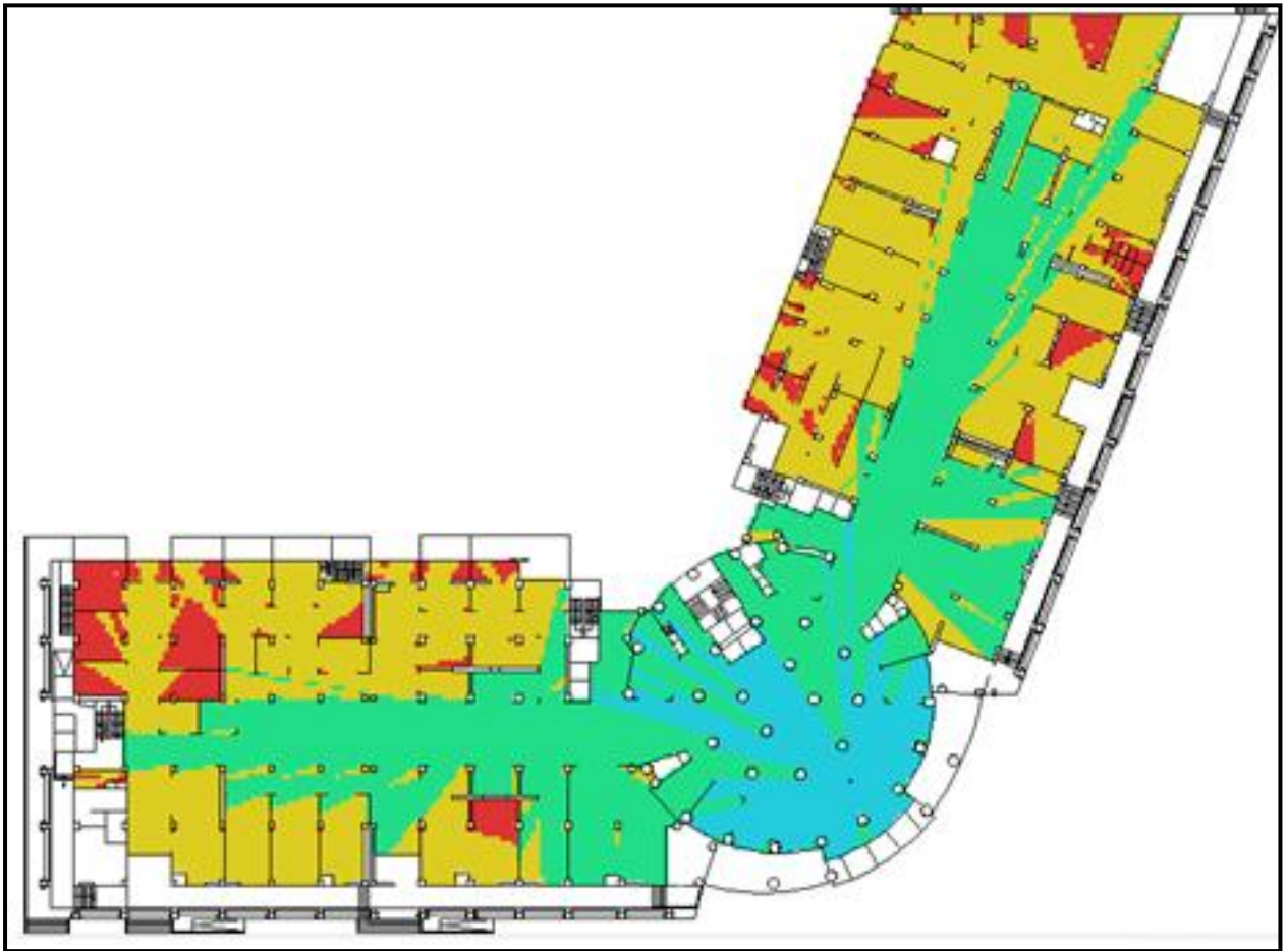
Fig. VII. 20 b: Résultats de la VGA pour les valeurs de la step depth du RDC.
