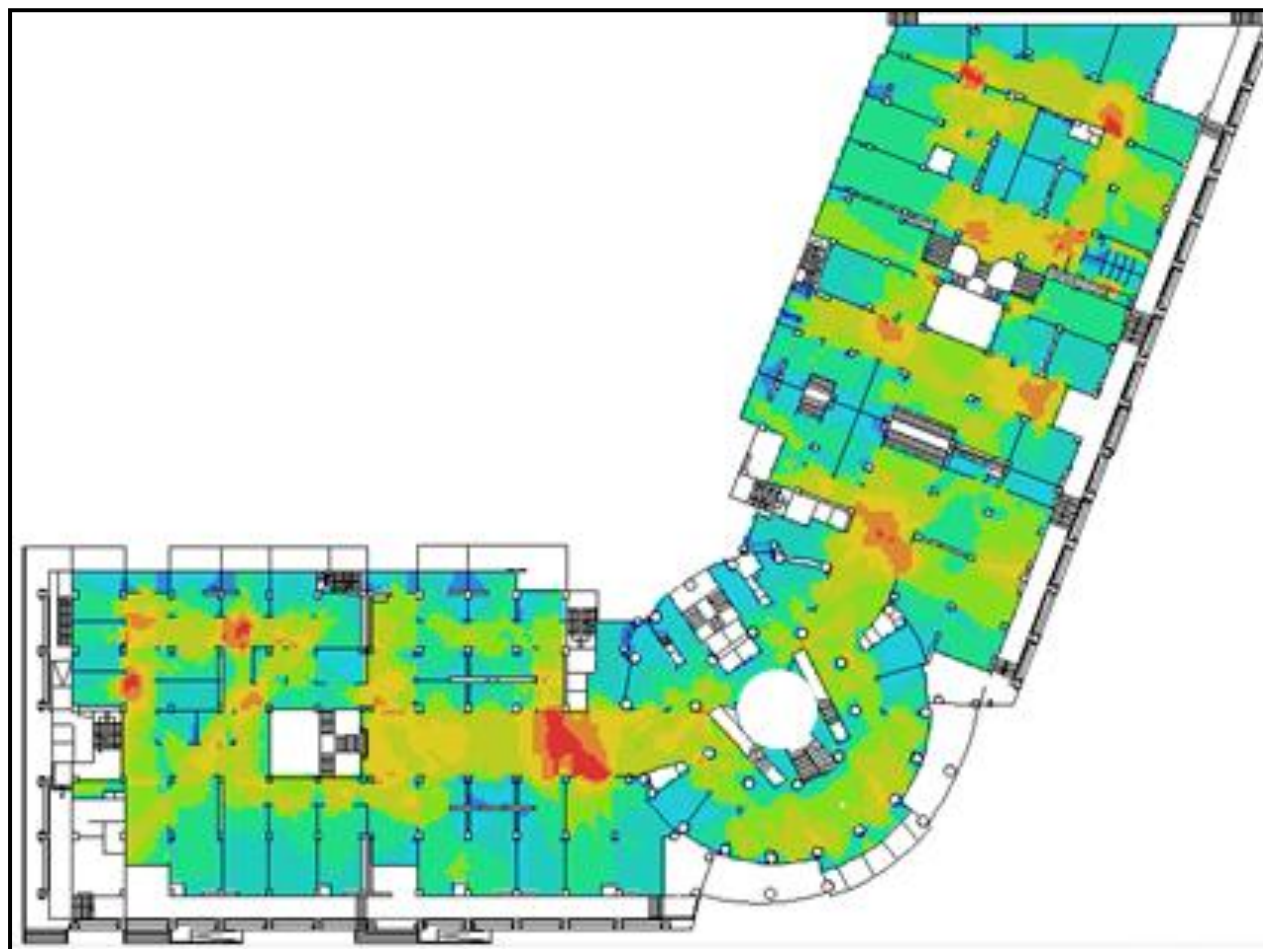
Fig. VII. 14 b: Résultats de la VGA pour les valeurs du contrôle visuel du RDC.
