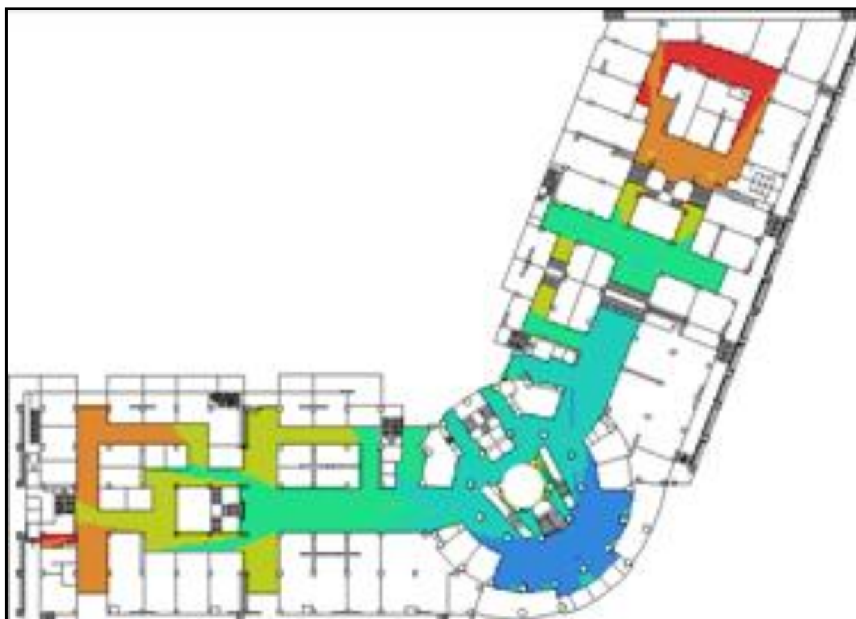
Fig. VII. 29 e: Résultats de la VGA pour les valeurs de la step depth du RDC.
