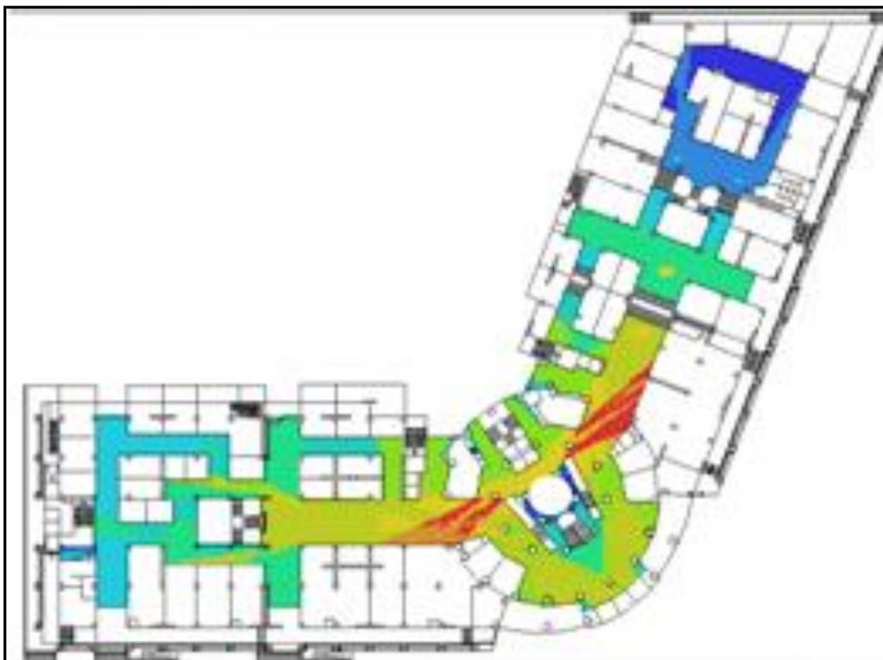
Fig. VII. 26 b: Résultats de la VGA pour les valeurs d'intégration visuelle du RDC.
