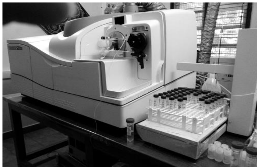
Figure 27: La spectrométrie de masse à plasma à couplage inductif ICP - MS de marque Pekin Elmer NexION 300.
