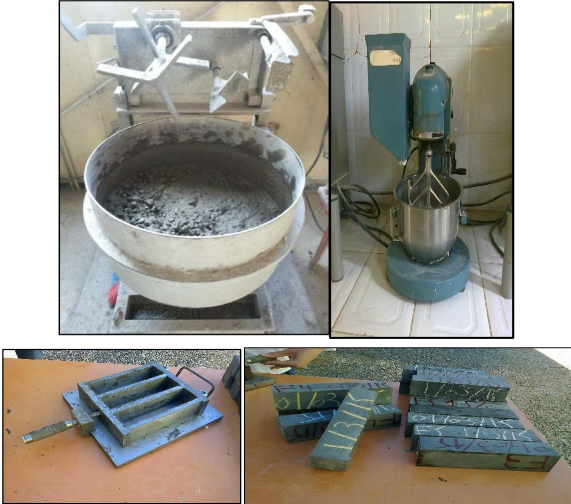
Figure III.8 : Malaxeurs, moules et éprouvettes utilisés pendant les essais
