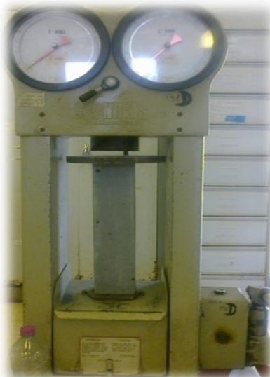
Figure III.16 : Essai de déformabilité : compression sur prisme 10 \times 10 \times 40 \text{ cm}^3 .
