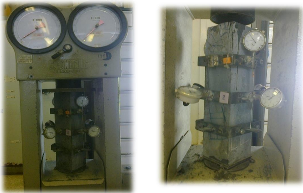
Figure III.17 : Essai de déformabilité : mesure des déformabilité pendant la compression du prisme de 10 \times 10 \times 40 \text{ cm}^3 .
