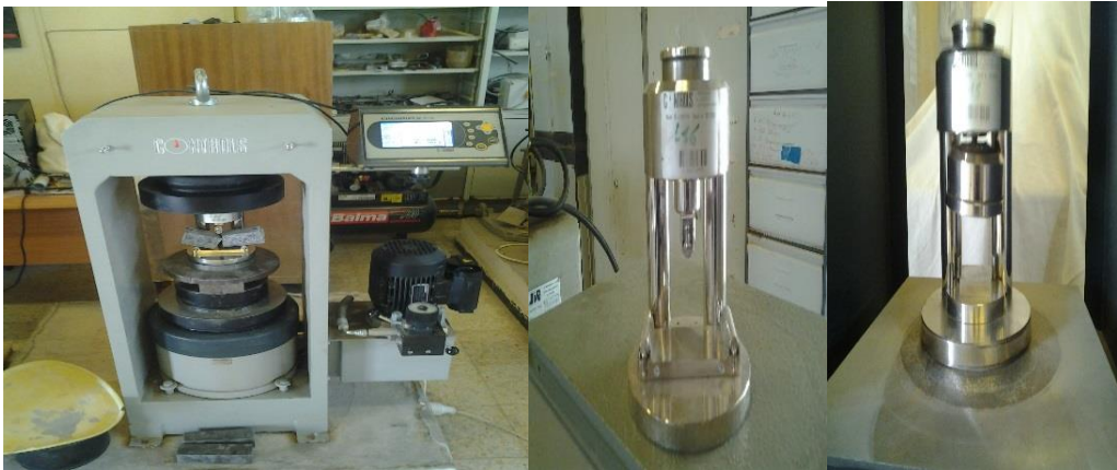
Figure III.12 : machine d'essais à la pression avec dispositif de compression et de traction
