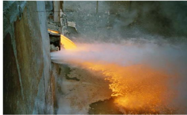
Figure I.5 : Granulation du laitier de haut fourneau d'El hadjar
