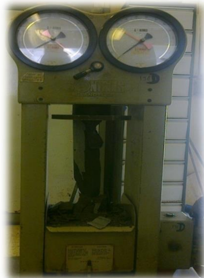
Figure III.16 : Essai de déformabilité : compression sur prisme 10 \times 10 \times 40 \text{ cm}^3 .
