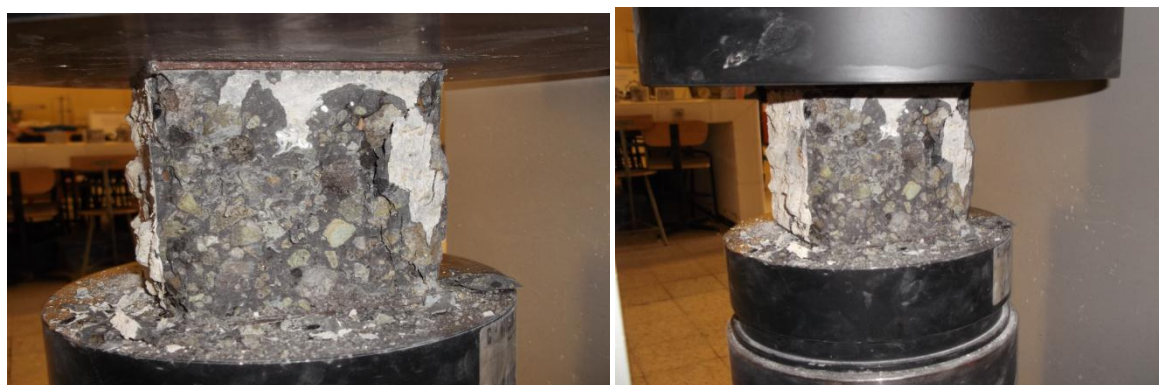
Photo (IV.9) : Eclatement du béton à base de laitier cristallisée de fraction 3/8 et la fraction 8/16.
