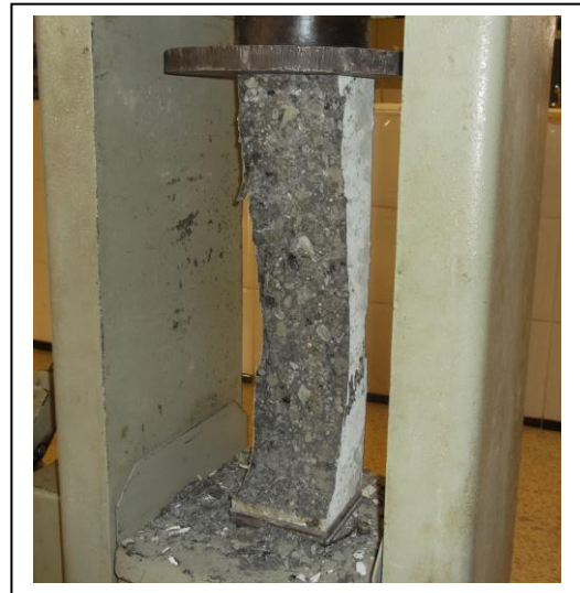
Photo (V.4) : Essai de déformabilité sur éprouvette prismatique (10x10x40) cm 3 .
