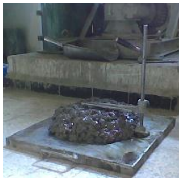
Photo (IV.2) : Essai d'affaissement.
