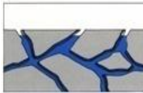
Figure (V.1) : Schéma des canaux capillaires et des vides dans le béton durci [111].
