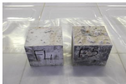
Photo (IV.4) : Résultats d'essais de compression sur éprouvettes (10x10x10) cm 3 pour le béton avec E/C = 0,30 à 14 jours.
