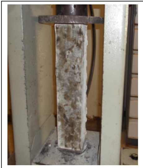
Photo (V.4) : Essai de déformabilité sur éprouvette prismatique (10x10x40) cm 3 .
