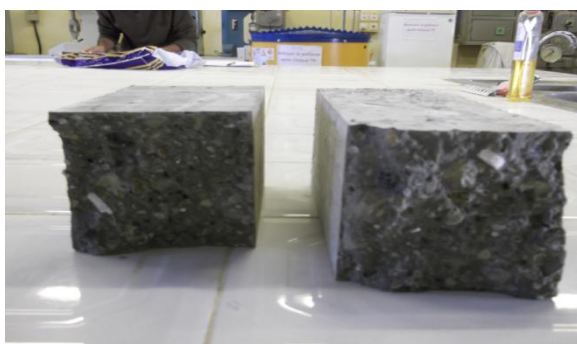
Photo (IV.12) : Rupture des épreuves du béton à base de laitier cristallisé de fraction 3/8 et la fraction 8/16.
