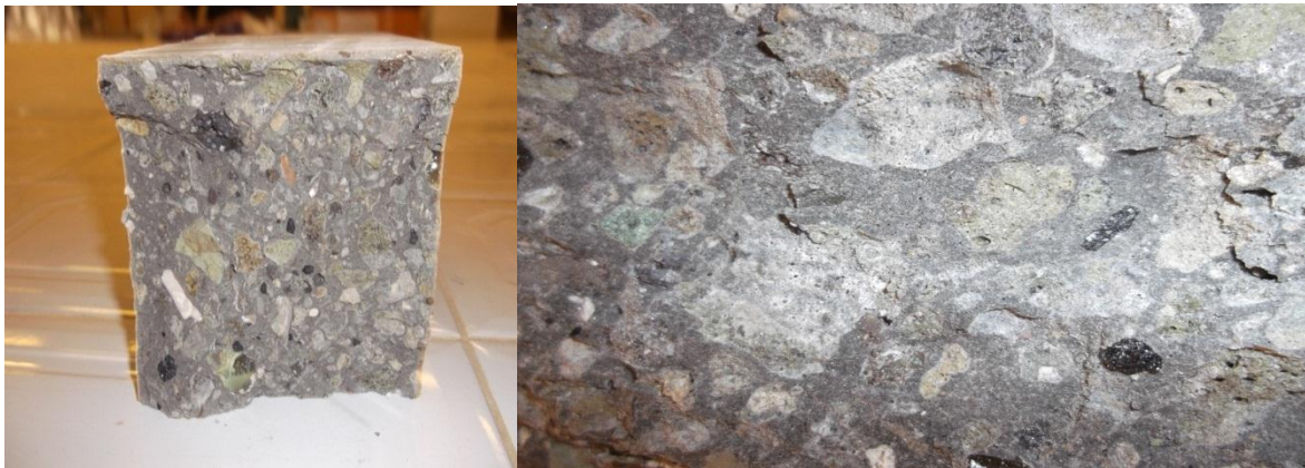
Photo (IV.6) : Macrostructure du béton à base de laitier cristallisée de fraction 3/8 et la fraction 8/16.
