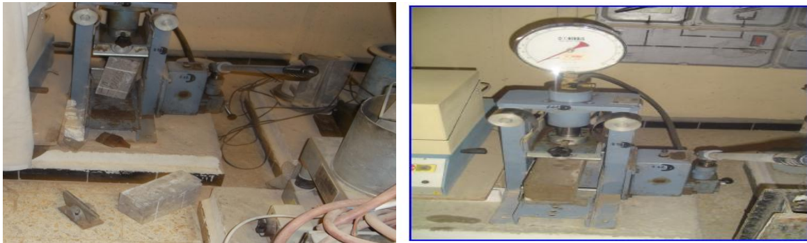
Photo (IV.10) : Dispositif de chargement pour l'essai de flexion.
