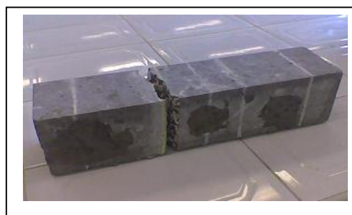
Photo (IV.12) : Rupture des épreuves du béton à base de laitier cristallisé de fraction 3/8 et la fraction 8/16.
