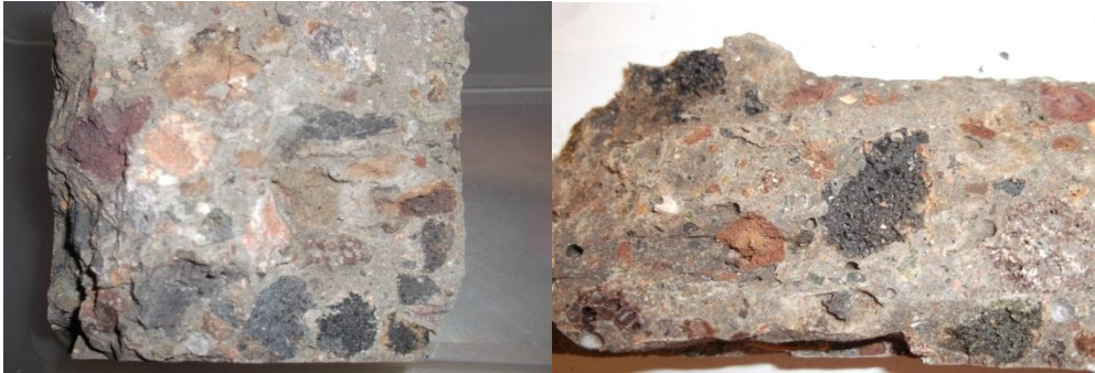
Photo (IV.5) : Macrostructure du béton à base de pouzzolane naturelle de fraction 3/8 et la fraction 8/16.
