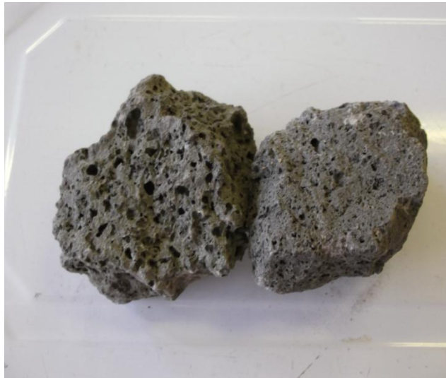
Photo (IV.7) : Macrostructure des granulats légers de laitier cristallisé.
