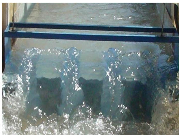
Figure II.12. Ecoulement d'un labyrinthe avec des porte-à-faux uniquement en amont pour un débit de 165 l/s.
