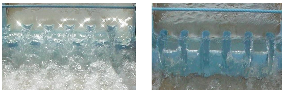
Figure II.2. Effet de la forme d'entrée sur l'écoulement pour un débit de 80 l/s (à gauche entrée plate – à droite entrée arrondie).
