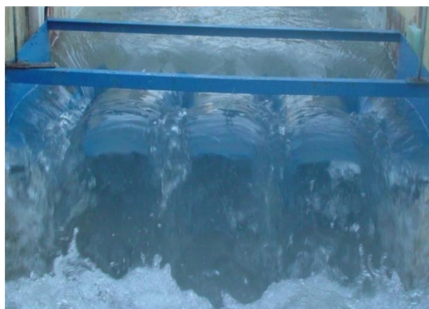
Figure II.11. Ecoulement d'un labyrinthe avec des porte-à-faux amont et aval pour un débit de 165 l/s.
