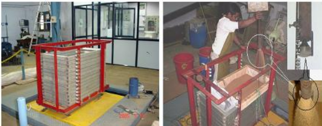
Figure 3.27 Test d'un mur sur table à secousse [Madhavi Latha et Krishna, 2008]
