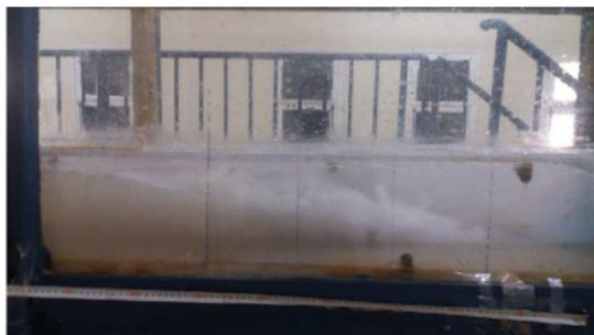
**Figure 5.7.** Photographie d'un ressaut hydraulique pour  $F_1 = 4,9$ .
