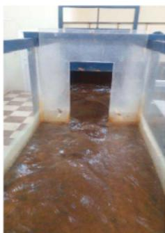
**Figure 5.4.** Déversoir rectangulaire sans hauteur de pelle avec contraction latérale.
