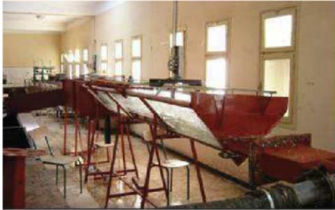
Figure 4.22. Photographie du canal de mesure utilisé.
