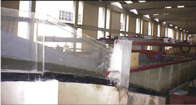
Figure 2.11. Canal de mesure selon (Carvalho et al. 2008).
